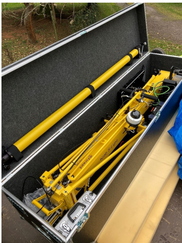
Obrázek 23 Měřicí vozík KRAB S – light složený v přepravní bedně
