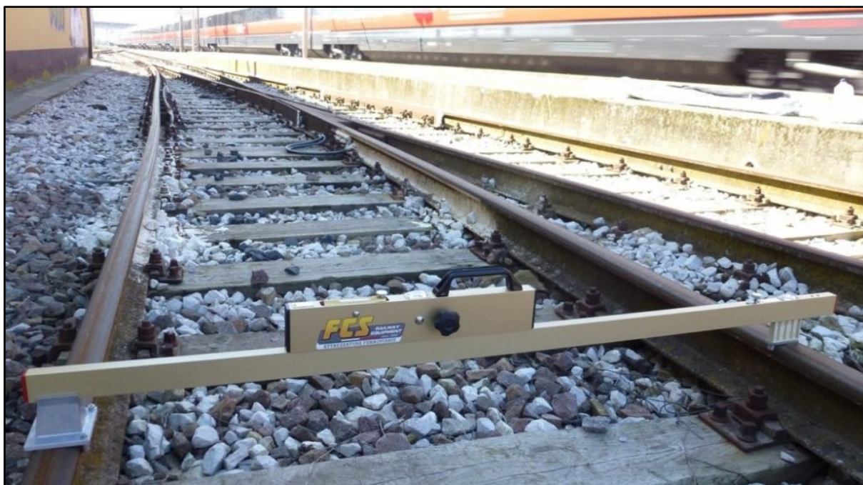
Obrázek 8 Rozchodka s nivelací pro převýšení [15]
