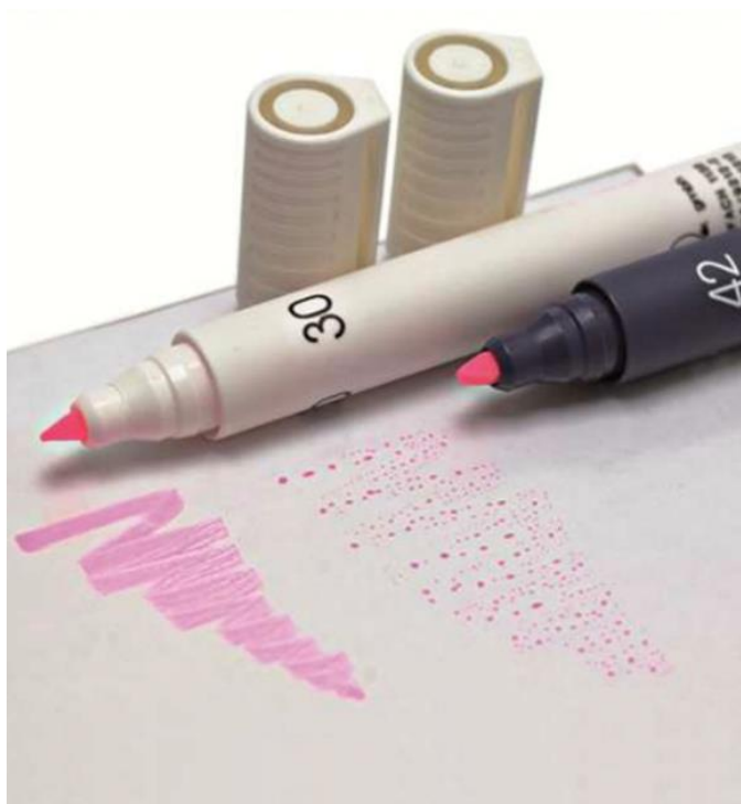
Obrázek 6 - Test povrchového napětí pomocí sady testovacích inkoustů [29]
