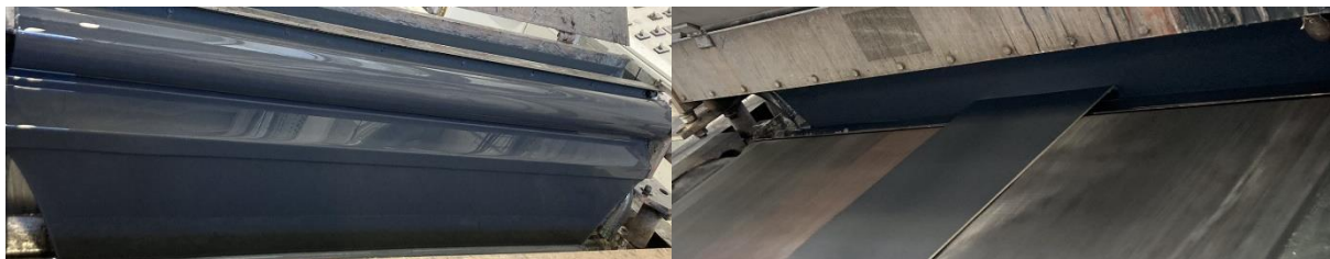
Obrázek 3 Aplikace pigmentovaných nátěrových hmot s obsahem vybraných koalescentů clonováním
