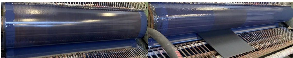
Obrázek 2 Aplikace pigmentovaných nátěrových hmot s obsahem vybraných koalescentů válečkováním
