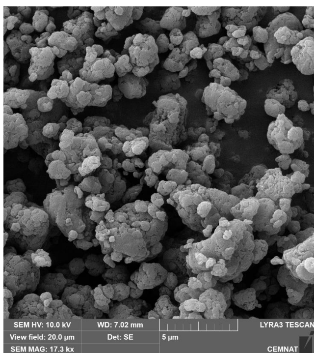
Obrázek 34: Snímek ze skenovacího elektronového mikroskopu znázorňující strukturu částic PANi-PTSA
