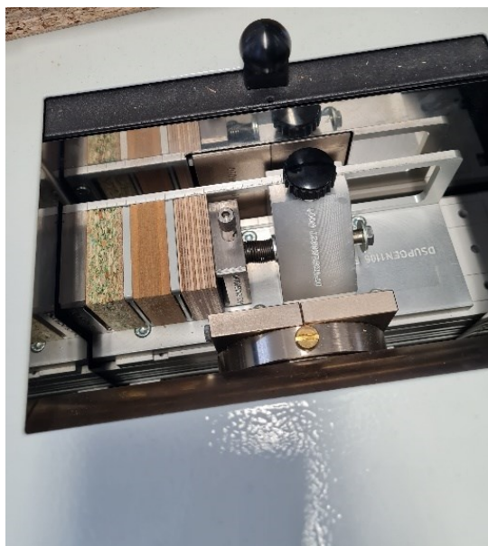
Obrázek 20 Uspořádání vzorku při měření vertikálního hustotního profilu
