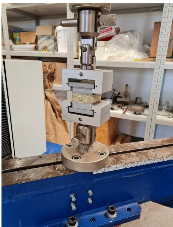
Obrázek 21 Uchycení vzorků pro měření pevnosti v tahu kolmo k rovině desky
