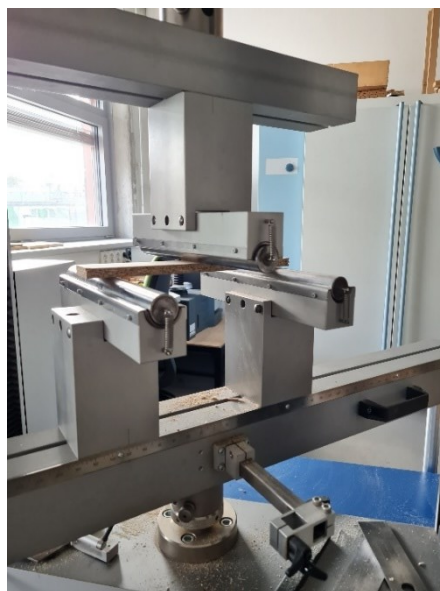
Obrázek 22 Měření zkoušky v ohybu dřevotřískových desek
