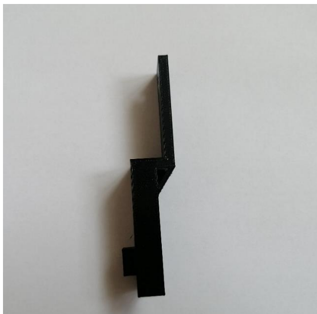
Obrázek 37 – Držák tyče na protějších stranách jeřábového mostu.
