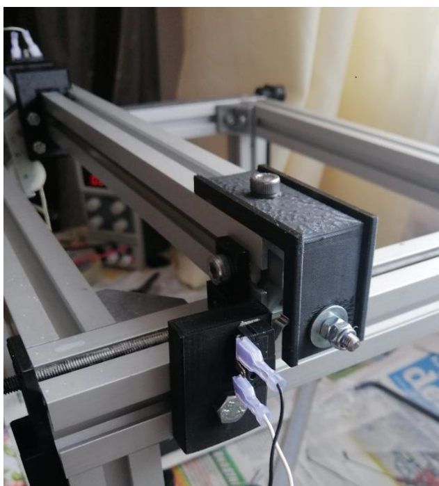
Obrázek 52 – Umístění koncového spínače na jeřábové dráze mostu
