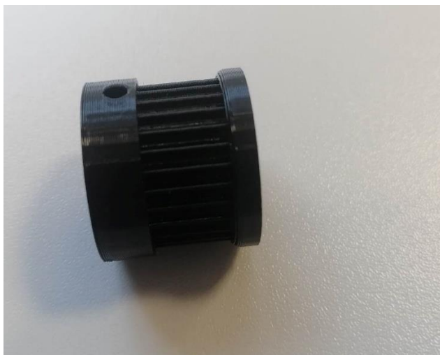
Obrázek 33 – Upravený mezikus pro provedení řemenového převodu.
