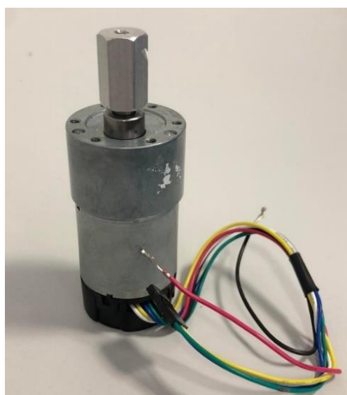
Obrázek 45 – Pohon pro pojezd mostu a jeřábové kočky
