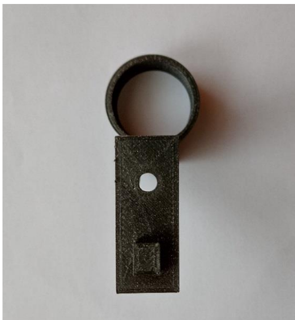
Obrázek 35 – Držák motoru mostového jeřábu pohled shora
