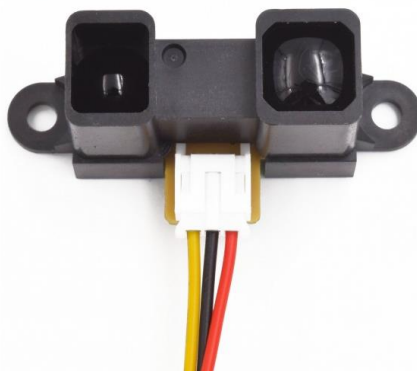
Obrázek 2.4 – Infračervený senzor vzdálenosti GPY0A02YK0F (Drátek.cz, 2022)
