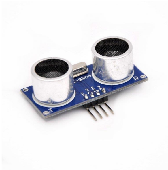
Obrázek 2.5 – Ultrazvukový senzor vzdálenosti HC-SR04 (laskakit.cz, 2022)
