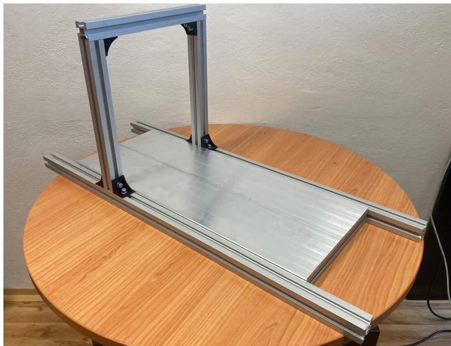
Obrázek 14 - Dopravník bez nohou a gumového pásu
