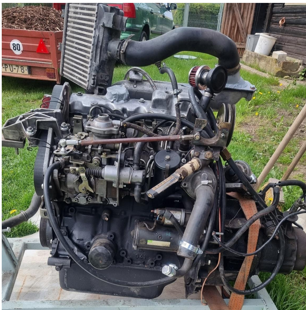
Obr. 16 Motor XUD7/TE umístěný na testovacím stojanu
