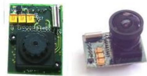
Obrázek 30. Kamerový modul JPEG COLOR CAMERA C328, zdroj [35]
