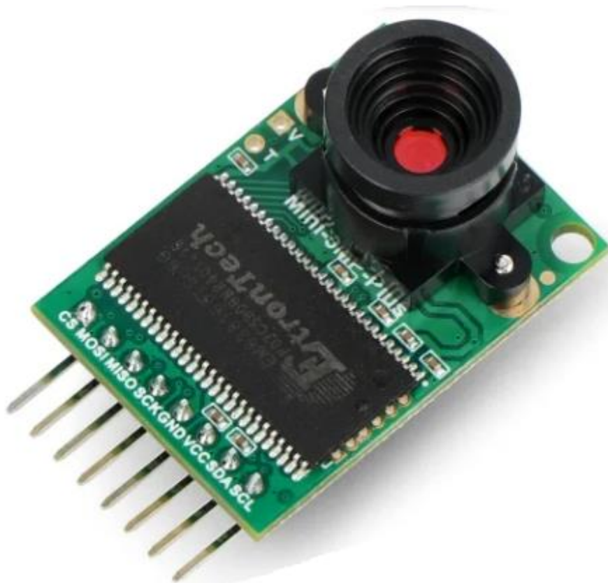
Obrázek 29. Kamerový modul Arducam – mini OV5642, zdroj [34]
