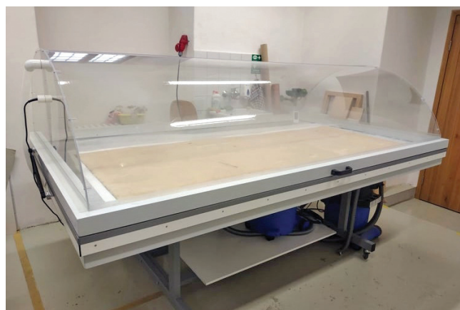
Obr. 5 Vlhčení díla v klimatizační komoře / Humidification of the work in a climate chamber
