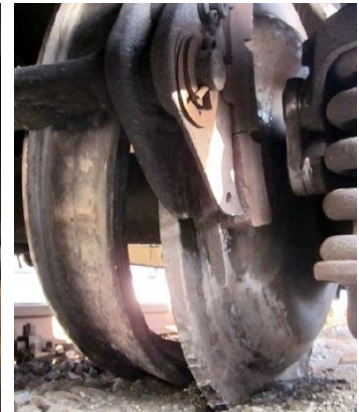
Obr. 5 Úplný lom desky kola; převzato ze zprávy [12].
