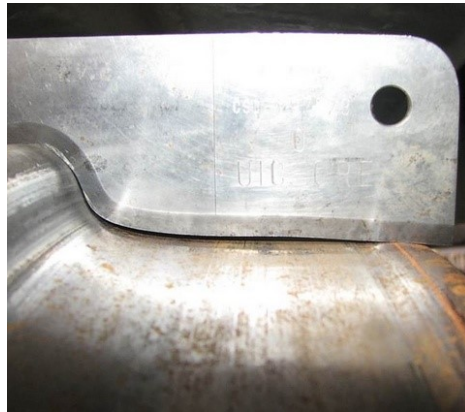
Obr. 4 Charakteristické projevy působení nekovových („K“ a „LL“) brzdových špalíků na kola: nápeče (vlevo) a projetý žlábek (vpravo); převzato z prezentace [11].
