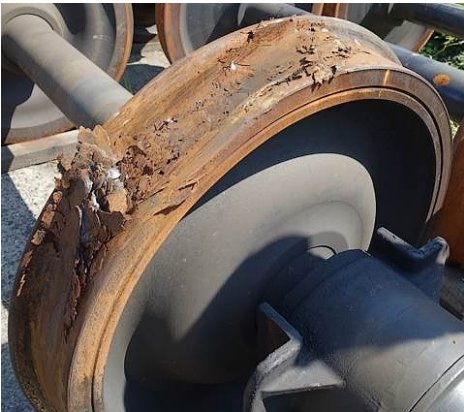
Obr. 4 Charakteristické projevy působení nekovových („K“ a „LL“) brzdových špalíků na kola: nápeče (vlevo) a projetý žlábek (vpravo); převzato z prezentace [11].
