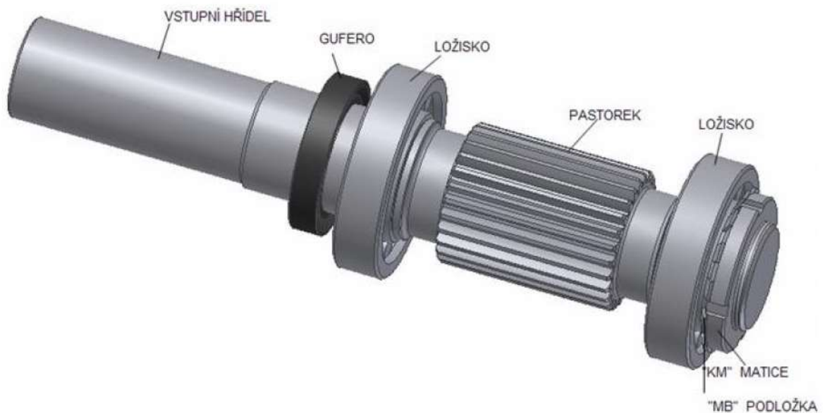
Obr. 3.4 Sestava hřídele a dalších strojních součástí
