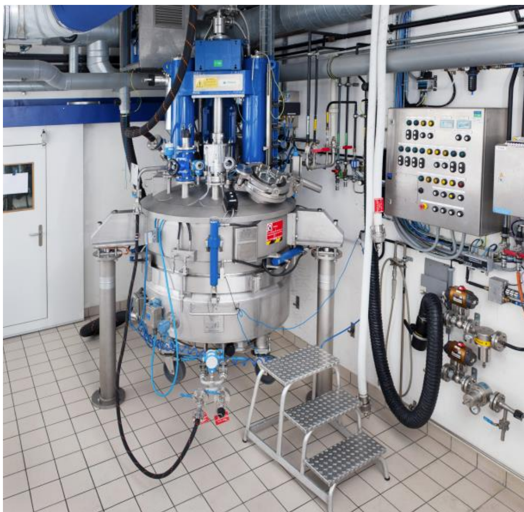
Obrázek 6: Reaktor SPPS pro produkci v řádu až kilogramů finálního peptidu
