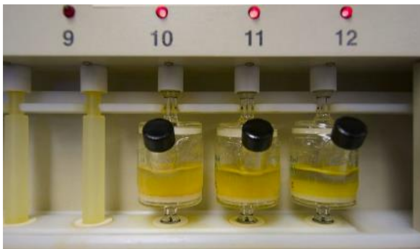
Obrázek 5: Automatizované SPPS pro syntézu peptidů v menším měřítku
