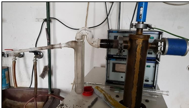
Obr. 22 Aparatura pro čištění arsenu, navržená a postavená v laboratoři.
