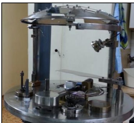
Obr. 26 Vnitřek napařovacího planetového zařízení (napařovačky) použitého pro přípravu tenkých filmů.
