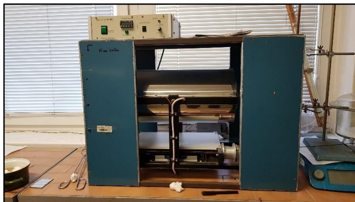
Obr. 24 Odporová kývací pec pro syntézu objemových vzorků skel.
