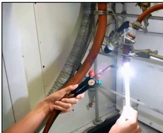
Obr. 23 Zatahování ampulí kyslíko-vodíkovým hořákem.
