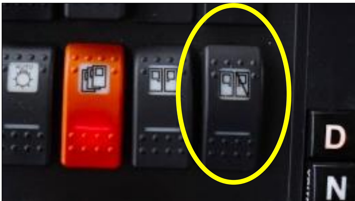
Obrázek I-9 – Tlačítka řidiče: Třípolohové tlačítko – přepínač nevratný
