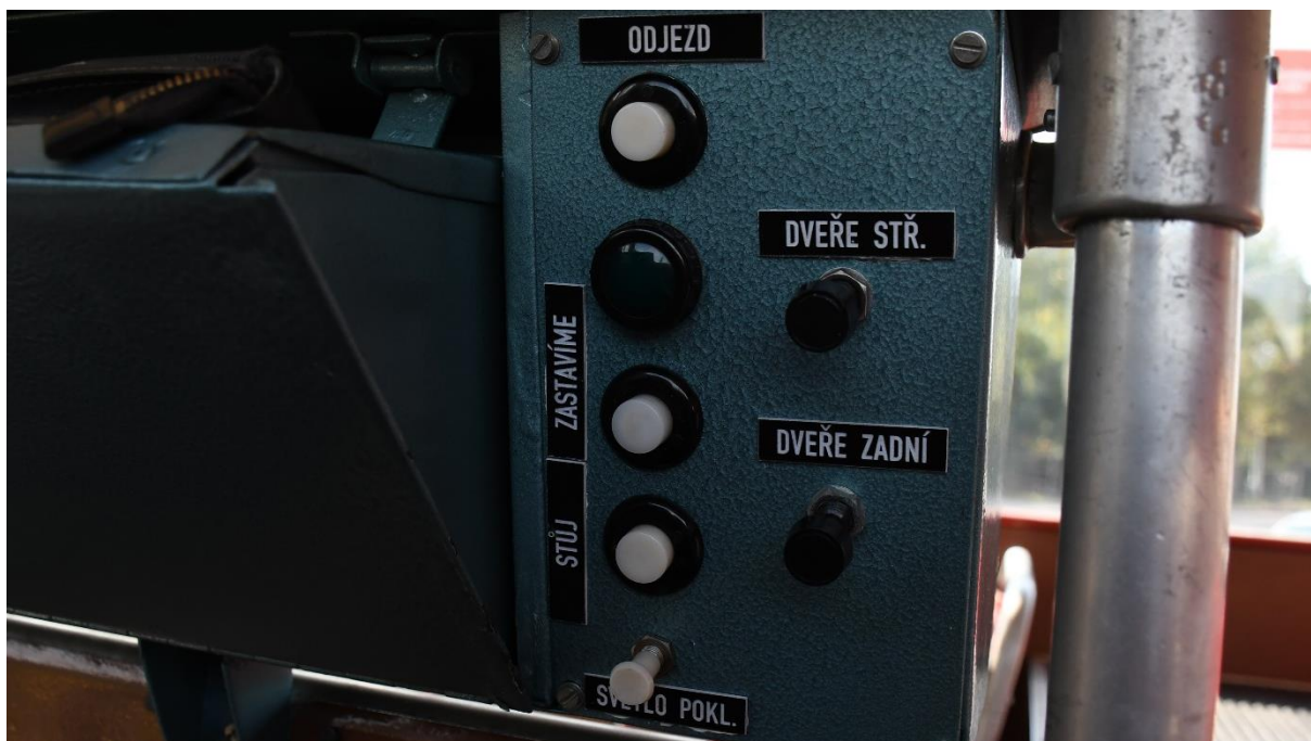
Obrázek H-1 – Tlačítka – Trolejbus: Škoda 8 Tr – pracoviště průvodčího
