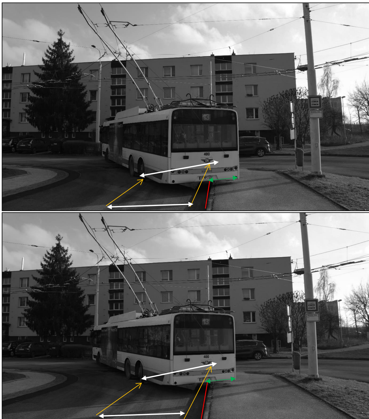
Obrázek B-8 – Délka vozidla: „Sd+“ – trolejbus: Škoda 28 Tr – odjezd ze zastávky – 2. část
