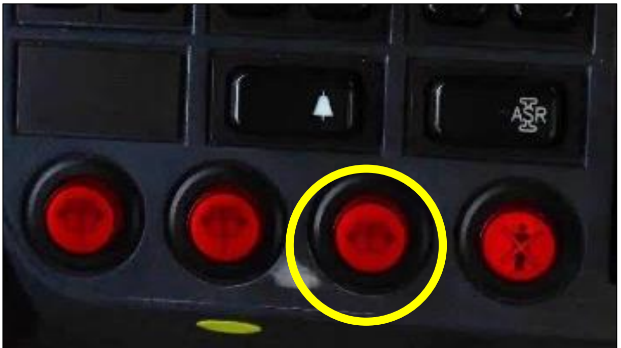
Obrázek I-1 – Tlačítka řidiče: Jednopolohové tlačítko – bez nutnosti držení tlačítka
