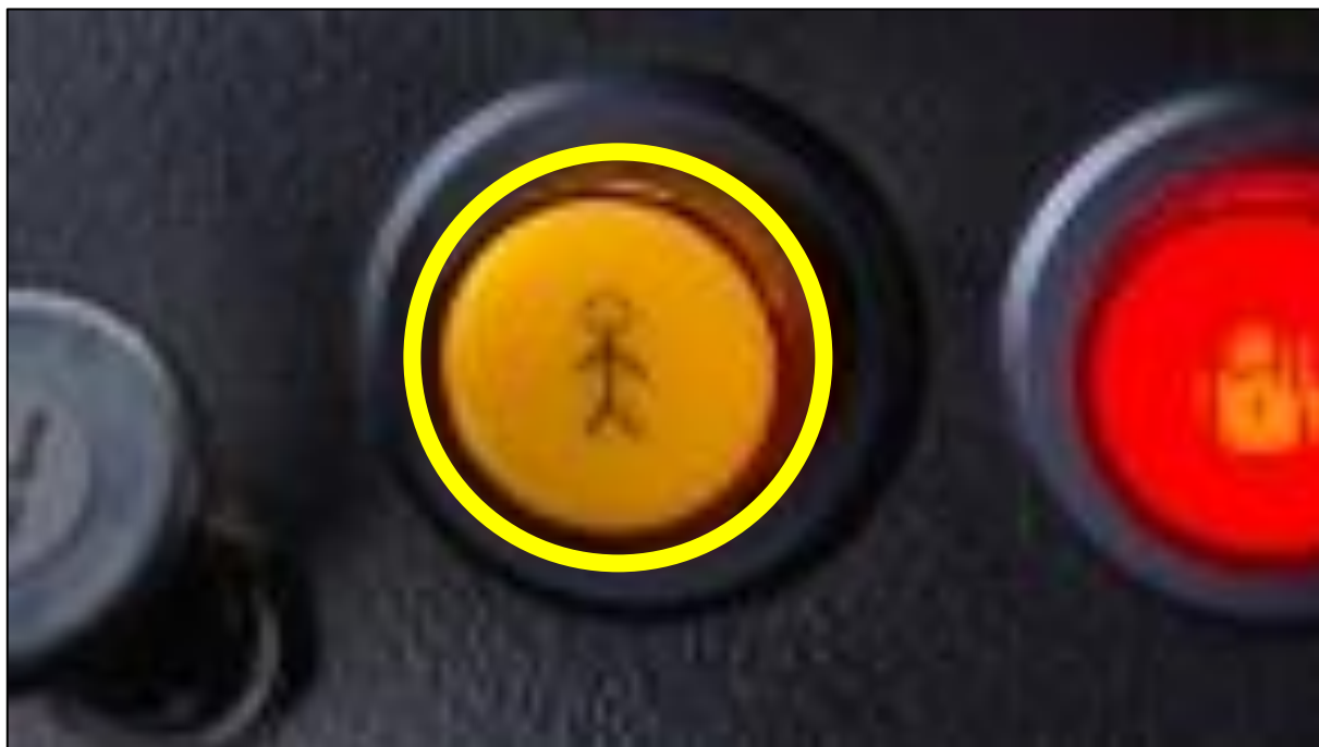
Obrázek I-2 – Tlačítka řidiče: Jednopolohové tlačítko – včetně nutnosti držení tlačítka
