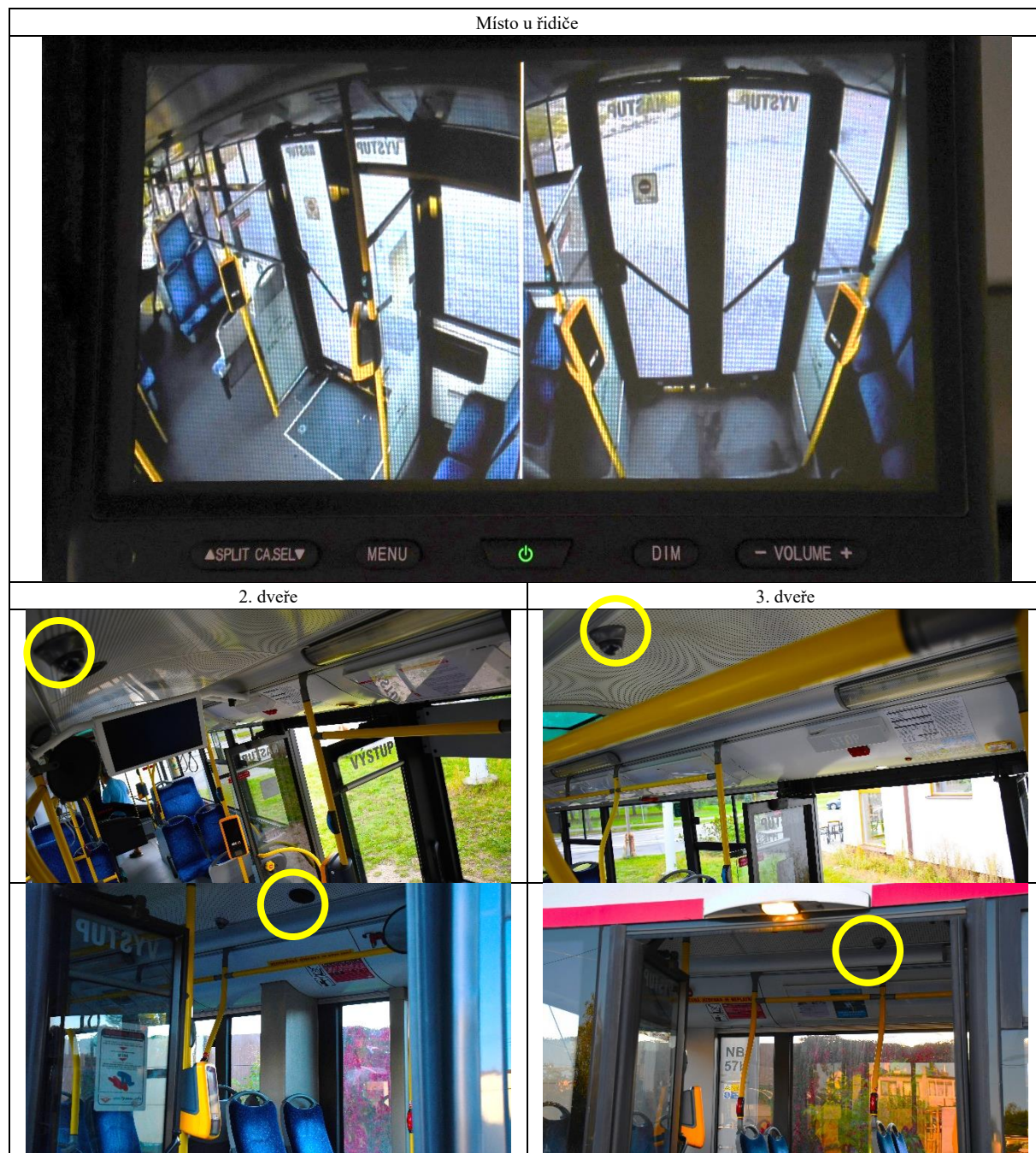
Tabulka J-2 – Kamerový systém – Trolejbus: Škoda 28 Tr Solaris (II. série)
