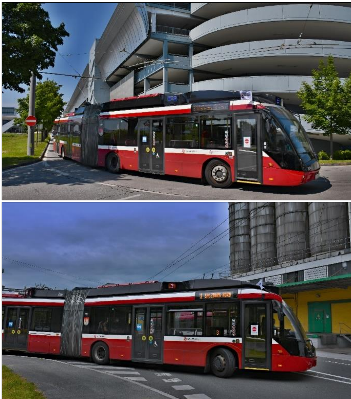
Obrázek B-10 – Délka vozidla: „Kb“ – trolejbus: Solaris Trolino 18 MS – odbočování
