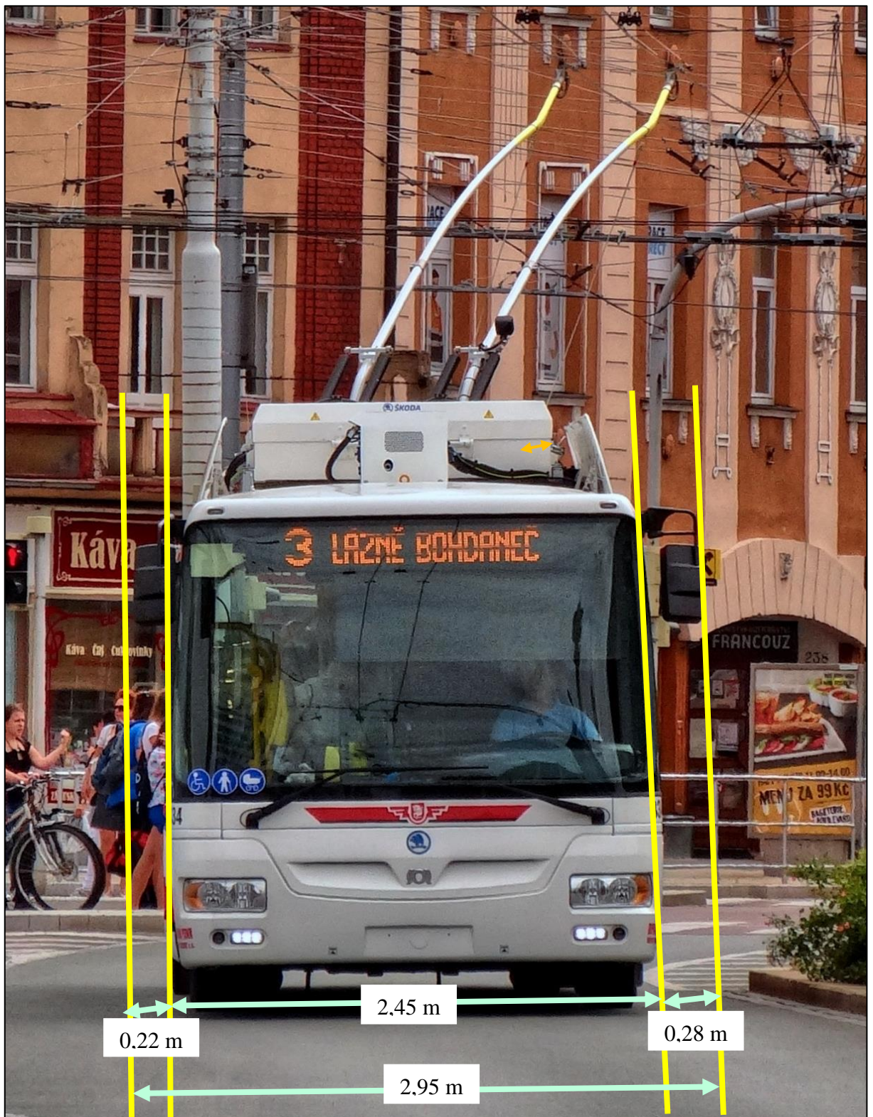
Obrázek B-16 – Šířka vozidla: trolejbus: Škoda 30 Tr Sor
