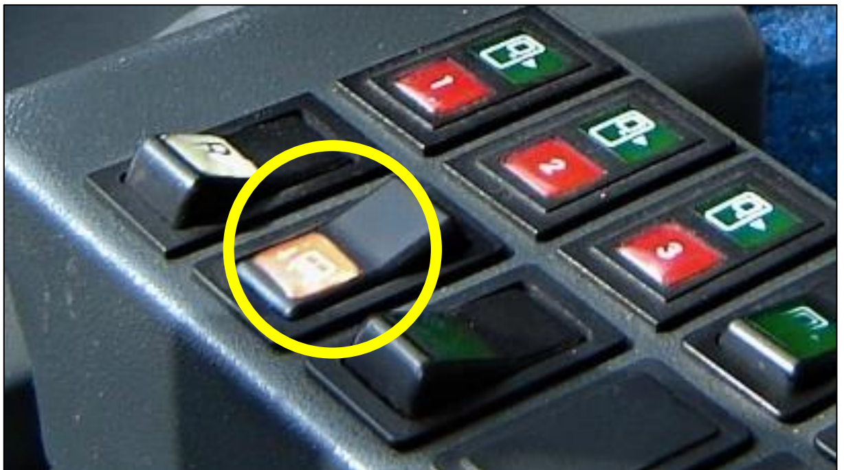
Obrázek I-5 – Tlačítka řidiče: Dvoupolohové tlačítko – přepínač nevratný – nezvedací
