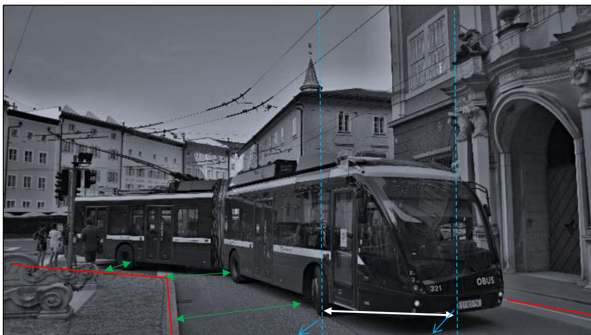
Obrázek B-9 – Délka vozidla: „Kb“ – trolejbus: Solaris Trollino 18 MS
