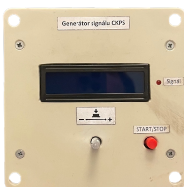
Obrázek 6: Stávající generátor - vrchní stěna
