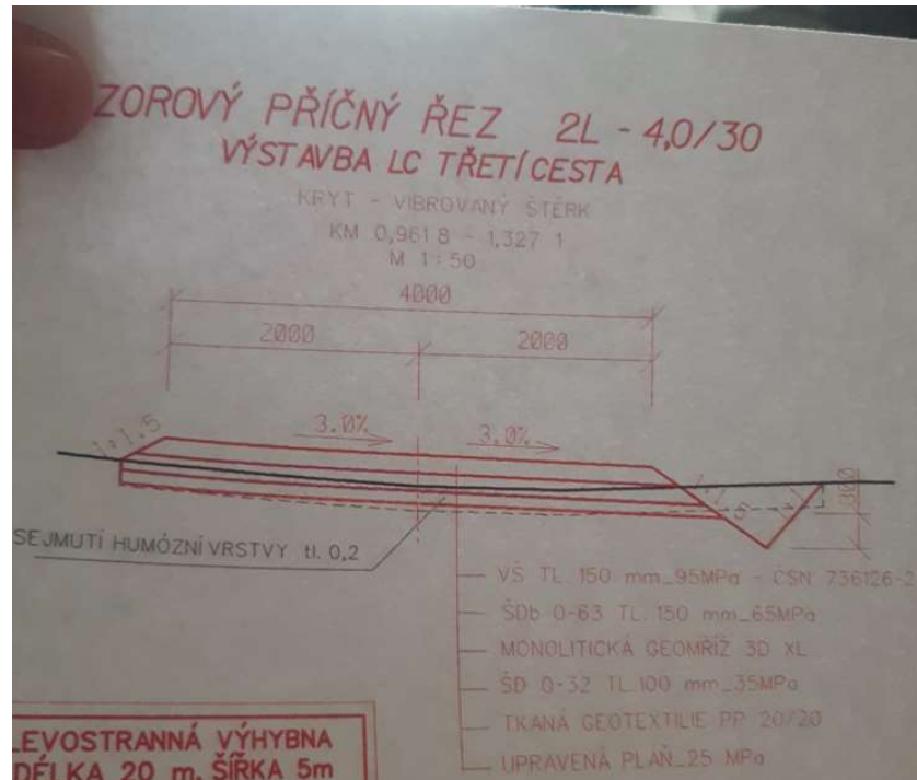
Obrázek 37 Konstrukční vrstvy úseku č.3 (zdroj: vlastní fotografie)
