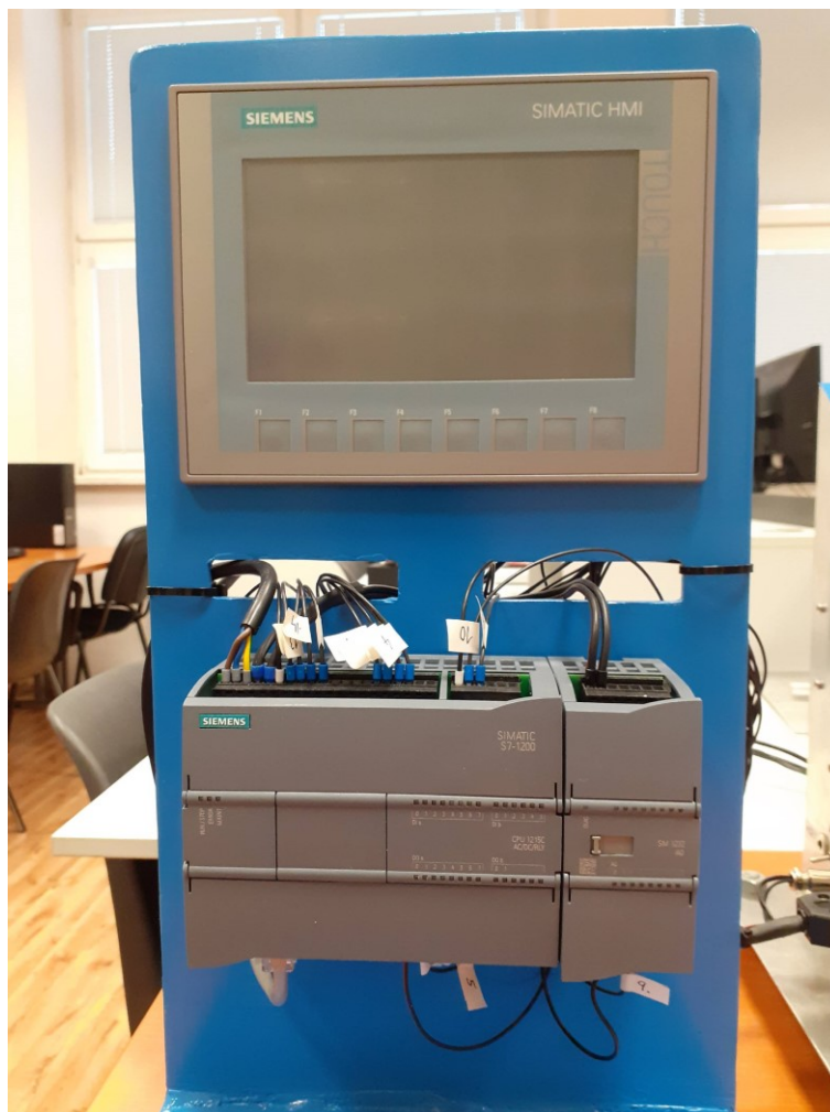
Obrázek 13 - PLC Siemens Simatic S7-1200 a Siemens HMI KTP700
