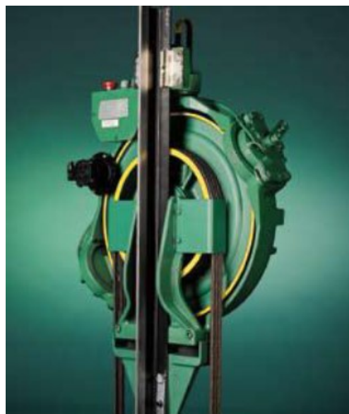
Obrázek 3- Bepřevodový pohon (DVOŘÁK, 2011a)
