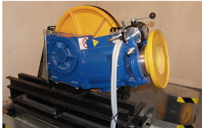
Obrázek 2 - Převodový stroj s třecím kotoučem (Pohony výtahů, nedatováno)
