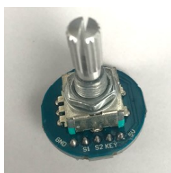
Obrázek 31 Enkodér s RC článkem
