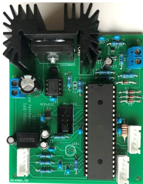
Obrázek 35 Osazená deska plošných spojů (bez připojených vodičů)
