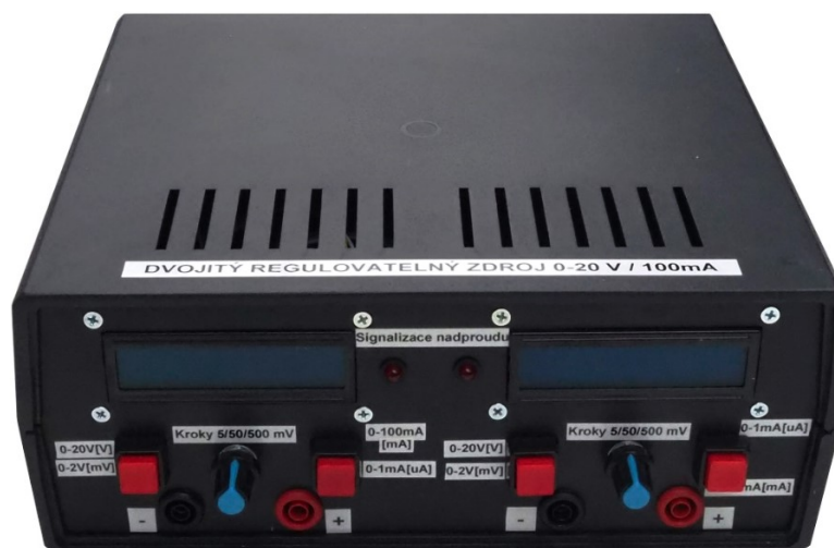
Obrázek 37 Finální vzhled dvojitého regulovatelného zdroje
