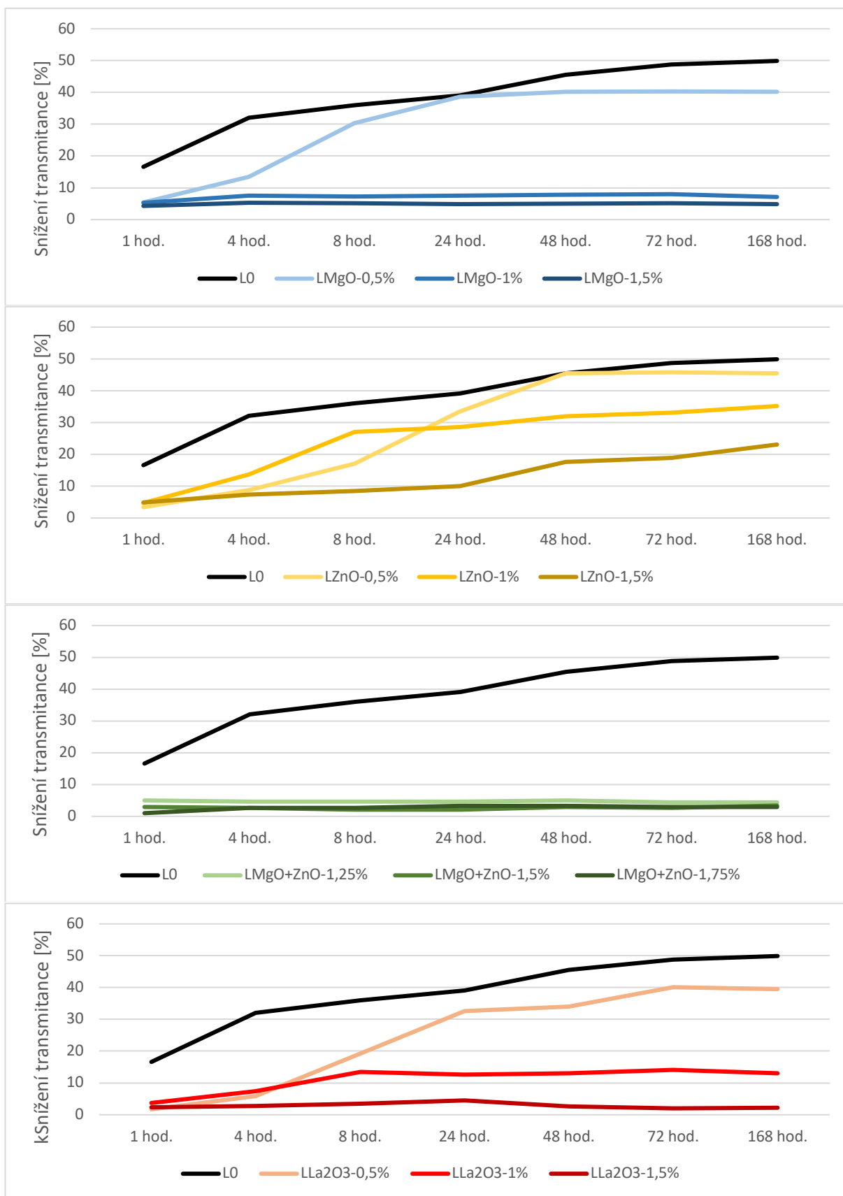
Obrázek 33 Bělení akrylátových povlaků po expozici vody v čase
