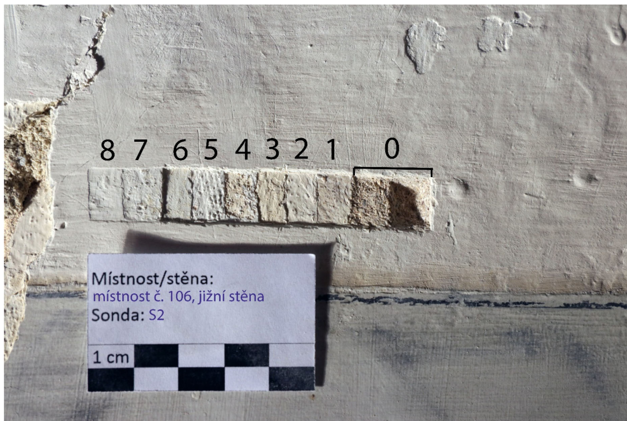
Obr. 22: Stratigrafická sonda na východní části jižní stěny, nad iluzivními mramory. V této oblasti je počet vrstev nižší, což zřejmě dokládá škrábání nesoudržných vrstev v rámci jedné z výmaleb.
