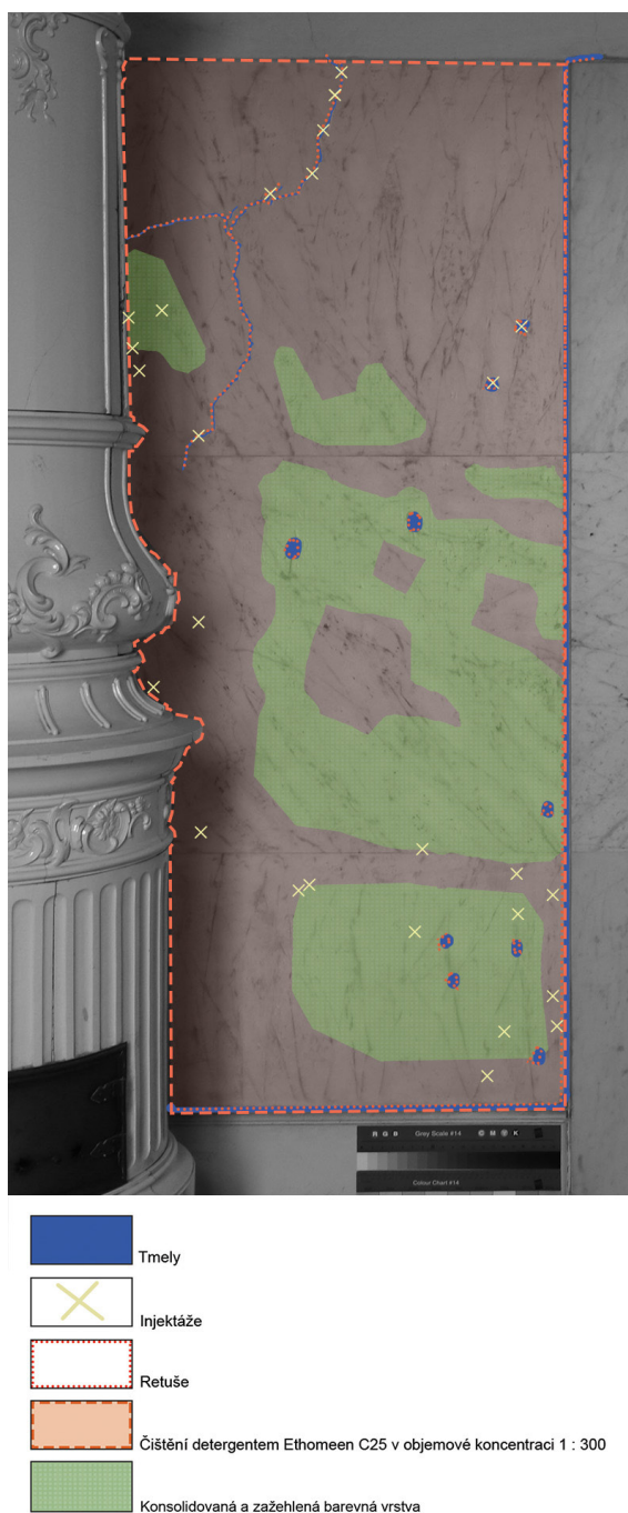
Obr. 16: Grafický zakres restaurátorského zásahu. Jižní část západní stěny.
