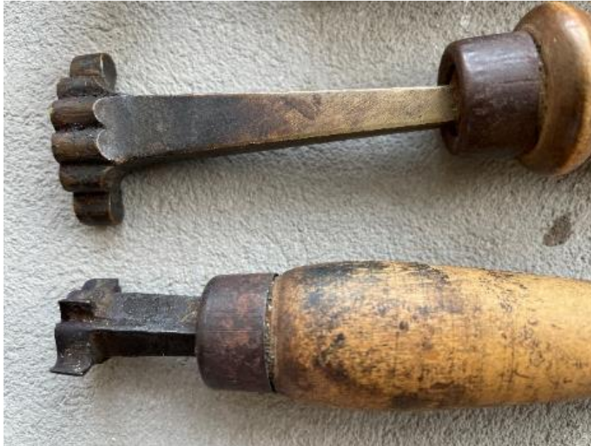
Detail dvou kolků s různě dlouhou trnovou částí sloužící k osazení do rukojeti. 79
