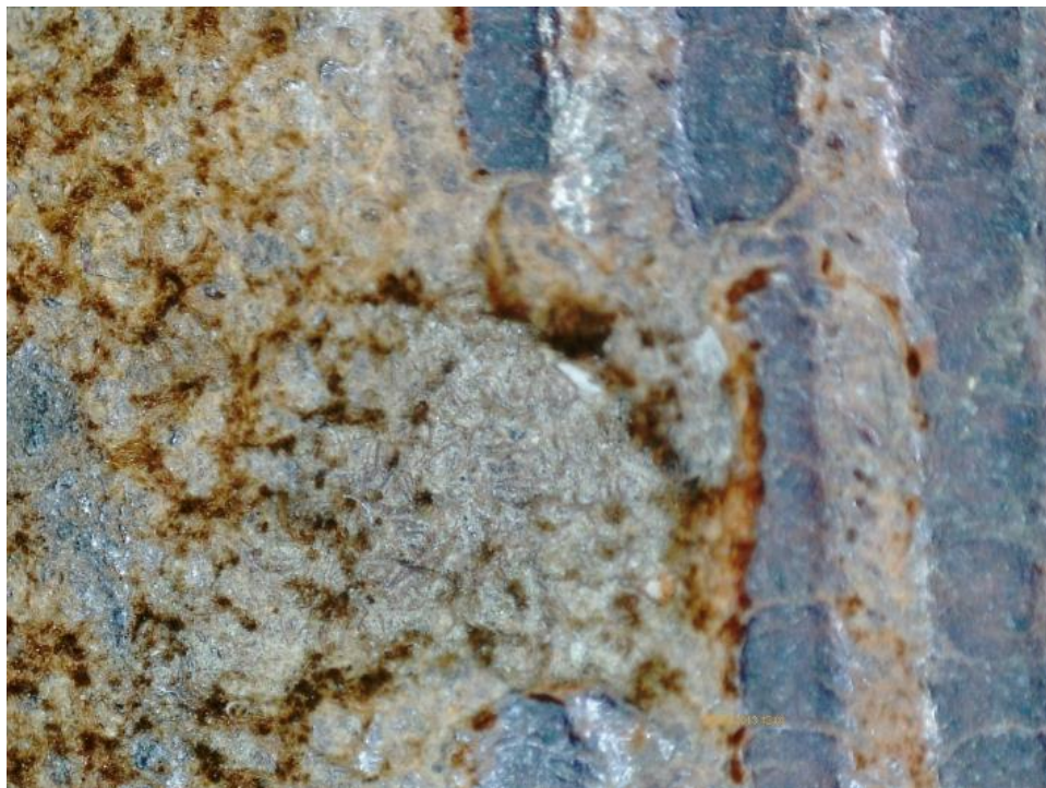
Detail štěpení usně – oddělování vrchní papilární vrstvy z koria – typické pro skopovice.
