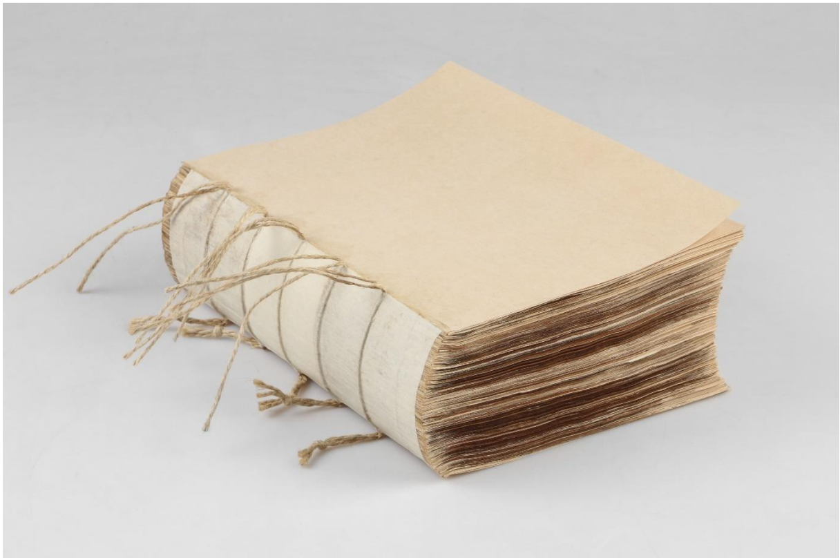
Fotografie 79 Knižní blok po zakulacení a přelepení hřbetu
