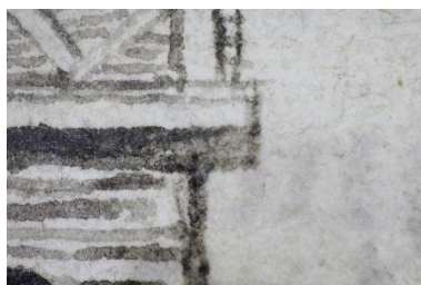
Obrázek A a 2 Vliv vody v kombinaci s otěrem na záznamový prostředek (vlevo před a vpravo po zkoušce)
