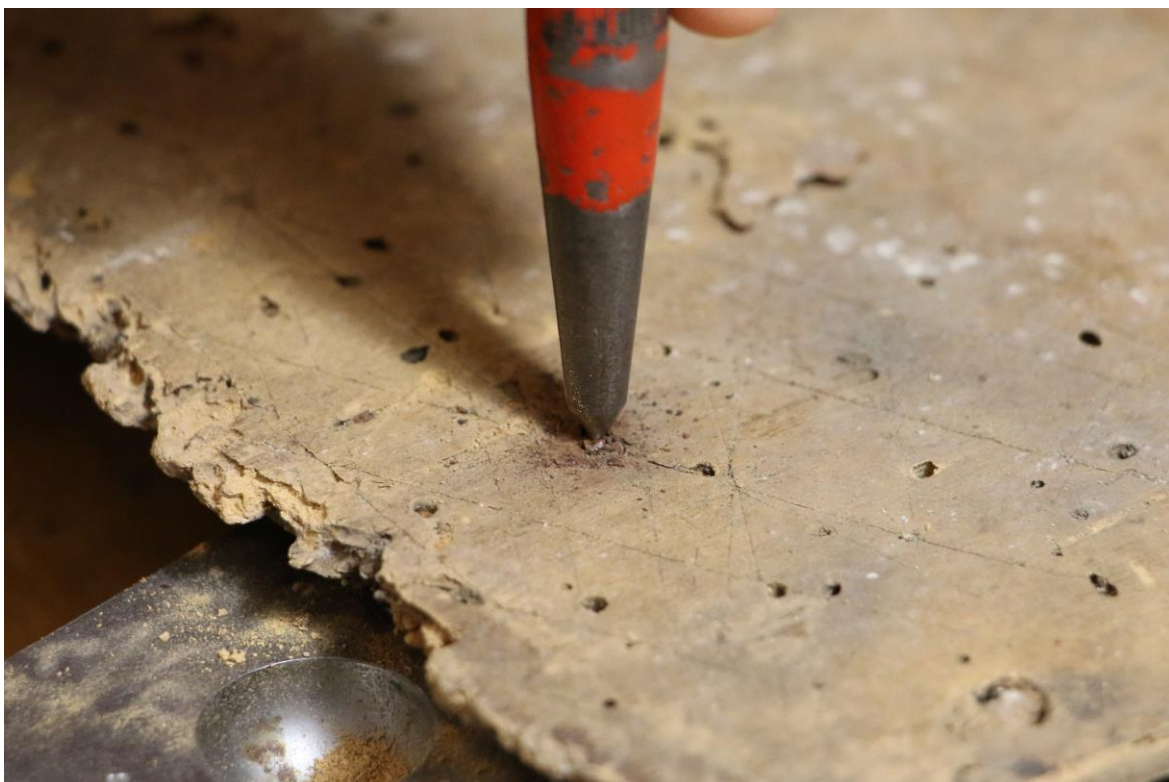
Obr. 17.65 Demontování kovových prvků
