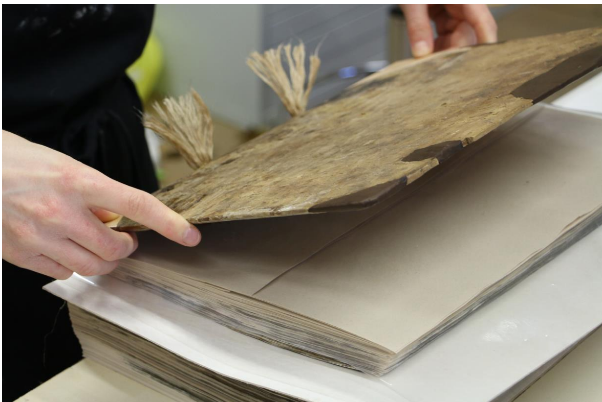
Obr. 17.91 Nasazování knižních desek
