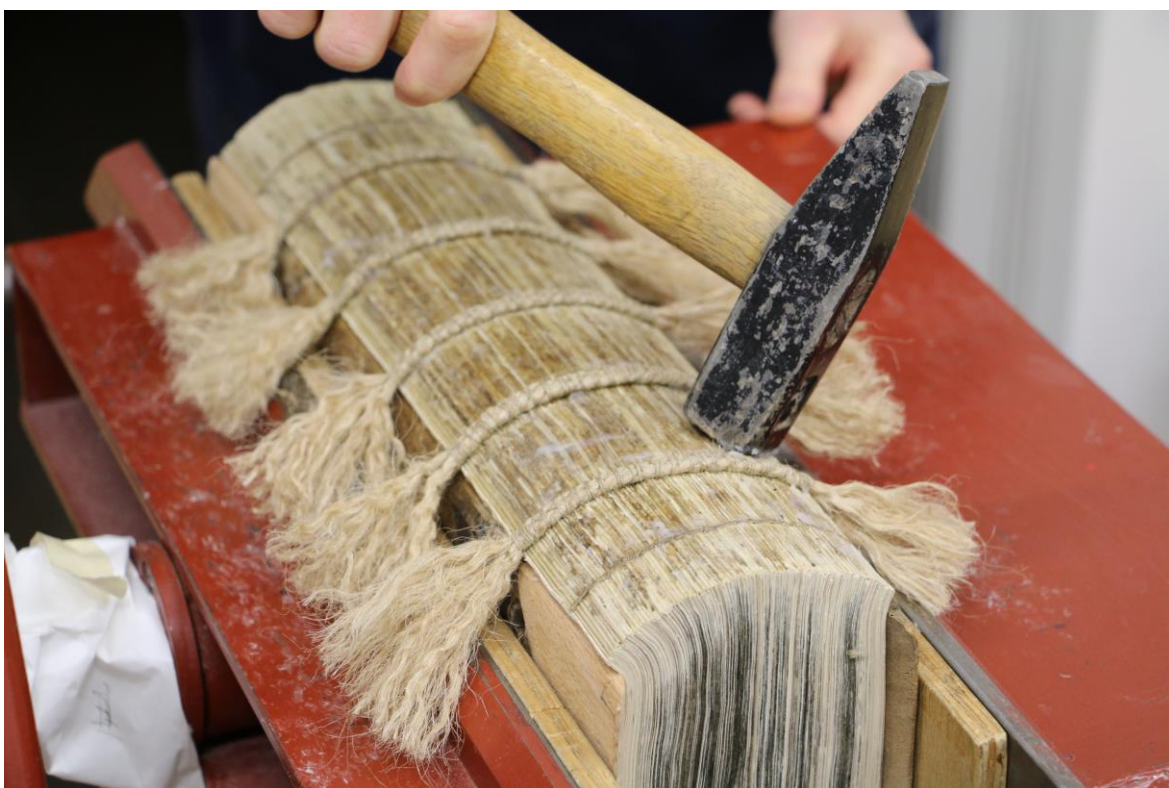
Obr. 17.82 Kulacení knižního bloku
