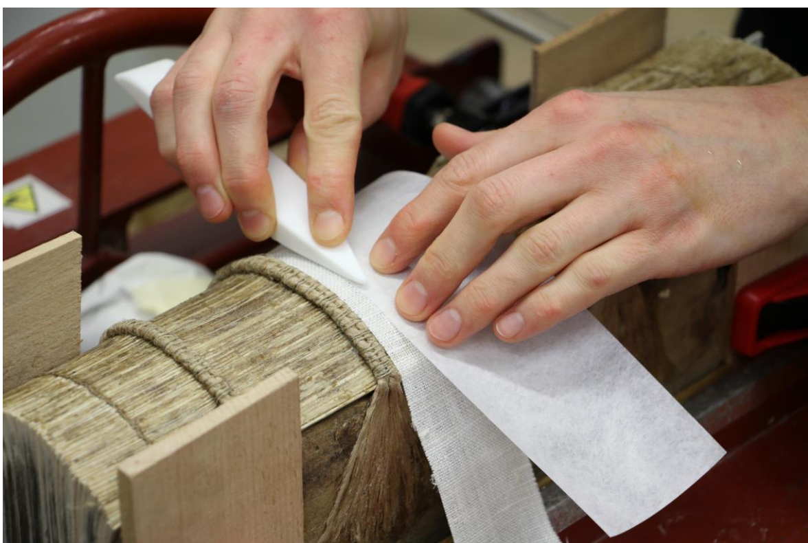
Obr. 17.92 Lepení mezivazných přelepů
