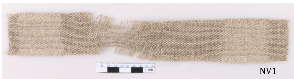
Obr. 142 Vzorek NV1 po jednoosých zátěžových zkouškách
