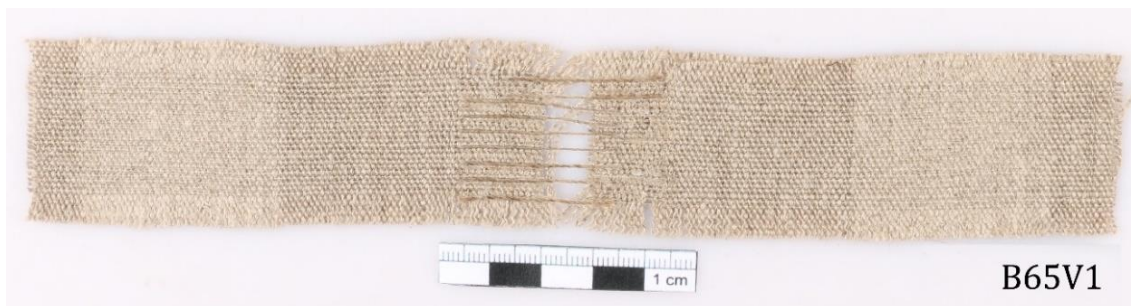
Obr. 145 Vzorek B65V1 po jednoosých zátěžových zkouškách
