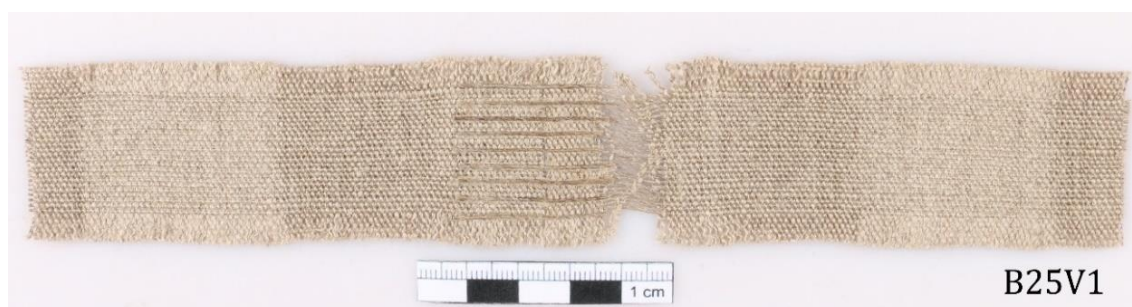
Obr. 146 Vzorek B25V1 po jednoosých zátěžových zkouškách
