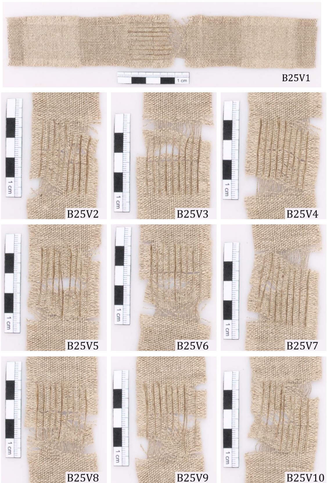
Obr. 153 Série B25V po jednoosých zátěžových zkouškách
