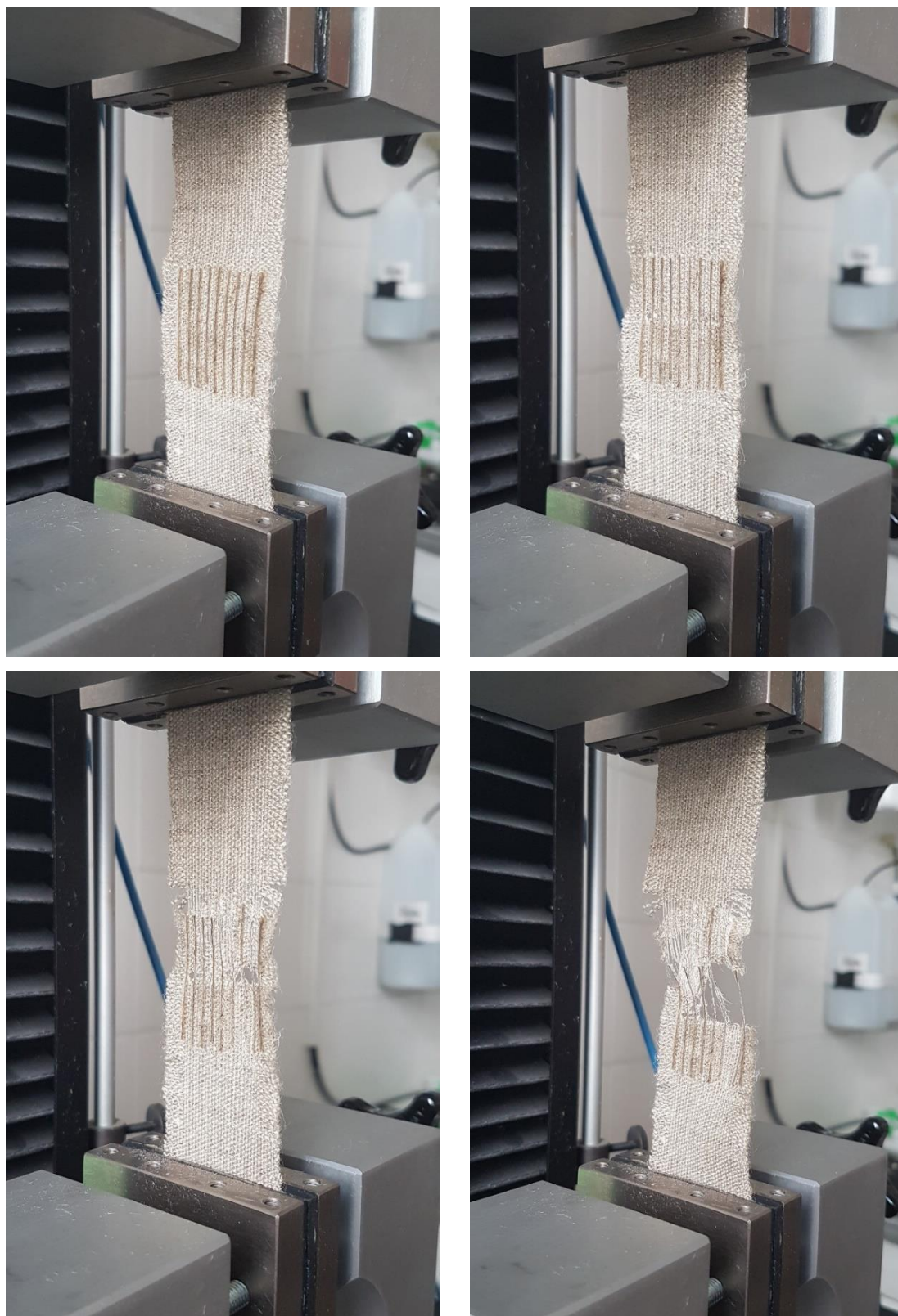
Obr. 149 Ukázka průběhu jednoosého zátěžového testu na vzorku BNV9
