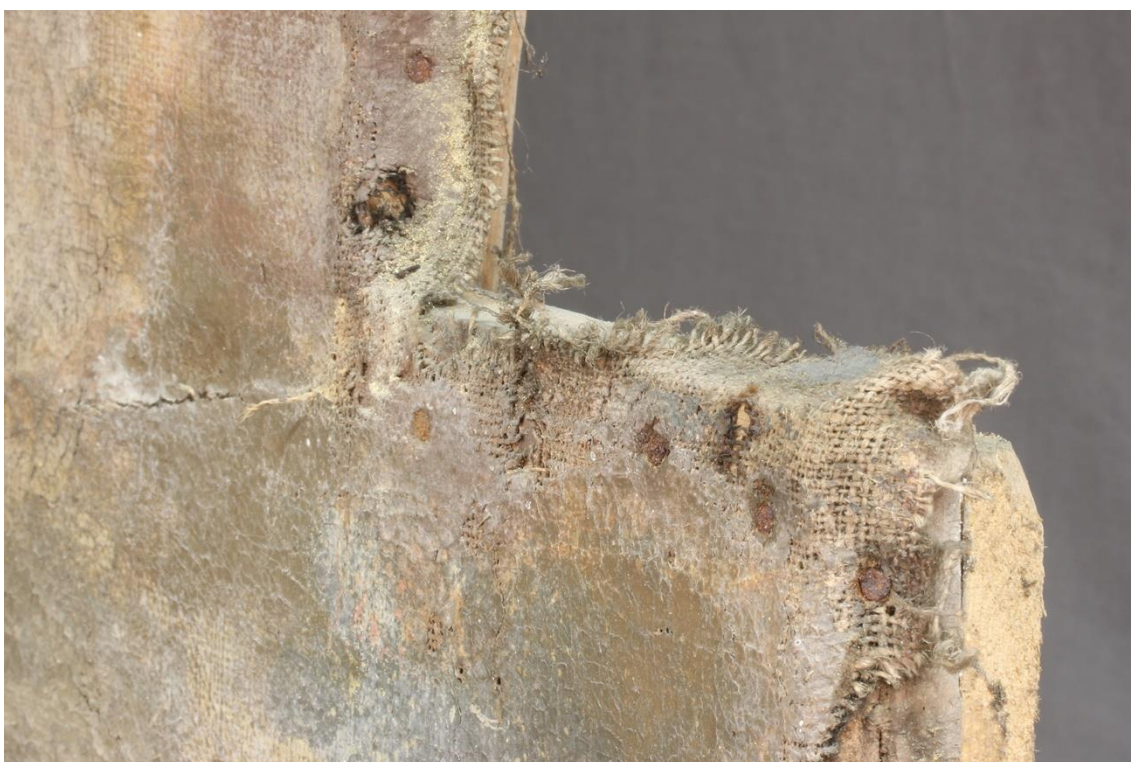
Obr. 100 LUX, František Julius. Sv. Barbora [olej na plátně]. Kostel sv. Jana Křtitele. Radomyšl. Perforace plátna způsobené oxidací kovových hřebů.
