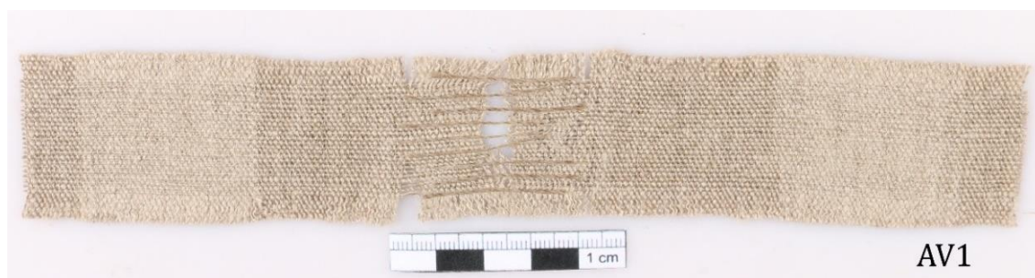
Obr. 147 Vzorek AV1 po jednoosých zátěžových zkouškách
