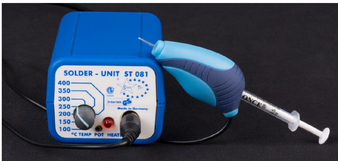
Obr. 114 Aplikátor adheziva pro scelování trhlin metodou nit na nit. In: DEMUTH, Petra, FLOCK, Hannah 2019, s. 136.
