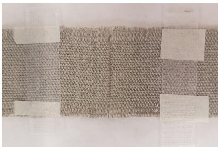
Obr. 132 Implementace trhliny zkušebních vzorků
