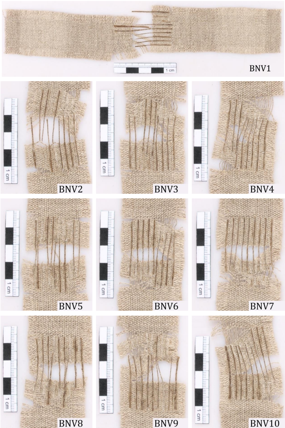
Obr. 151 Série BNV po jednoosých zátěžových zkouškách
