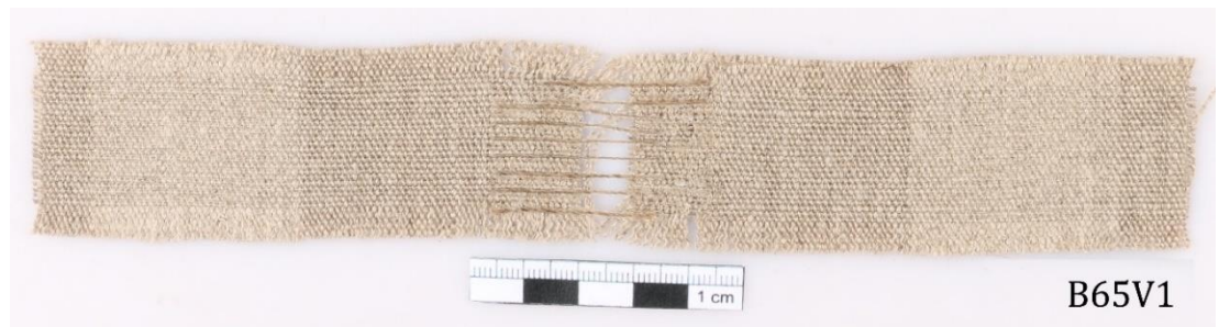
Obr. 152 Série B65V po jednoosých zátěžových zkouškách
