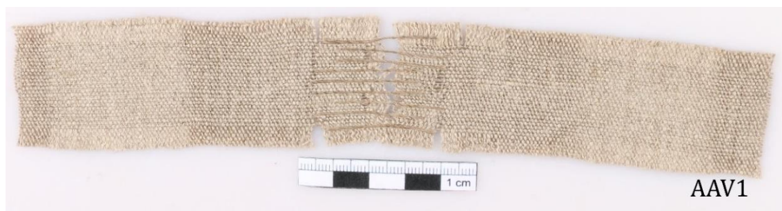
Obr. 148 Vzorek AAV1 po jednoosých zátěžových zkouškách
