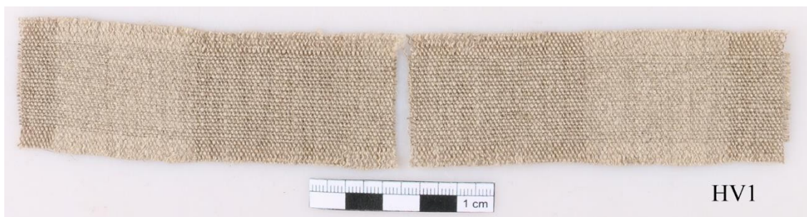
Obr. 143 Vzorek HV1 po jednoosých zátěžových zkouškách
