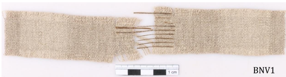
Obr. 144 Vzorek BNV1 po jednoosých zátěžových zkouškách
