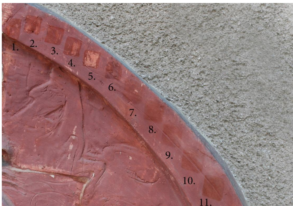
Obrázek 5: Zkoušky konsolidace barevné vrstvy:
