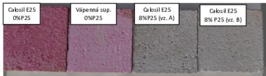
Obr. 3 Barevná změna Rhodaminu B na referenčních vzorcích bez obsahu TiO 2 (vlevo) a na vzorcích s obsahem 8 hm% TiO 2 P25 v pojivu Ca losil E25. Zachyceno po 26 hodinové expozici UV záření
