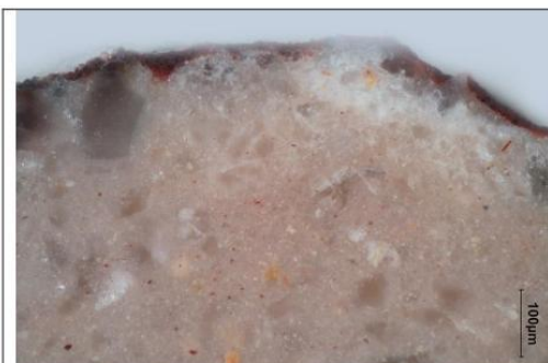
Mikrofoto v bílém odraženém světle, nábrus, fotografováno při zvětšení 200x
