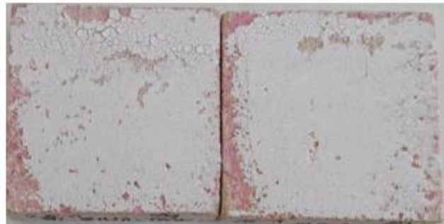
Obr. 4 Barevná změna Rhodaminu B na vzorcích s obsahem 8 hm% TiO 2 P25 ve vápenné suspenzi. Zachyceno po 26 hodinové expozici UV záření
