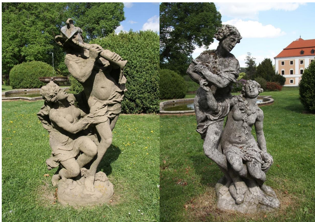
obr. 13 Porovnání faksimile umělého kamene pojeného epoxidovou pryskyřicí a faksimile z umělého kamene pojeného cementem vpravo
