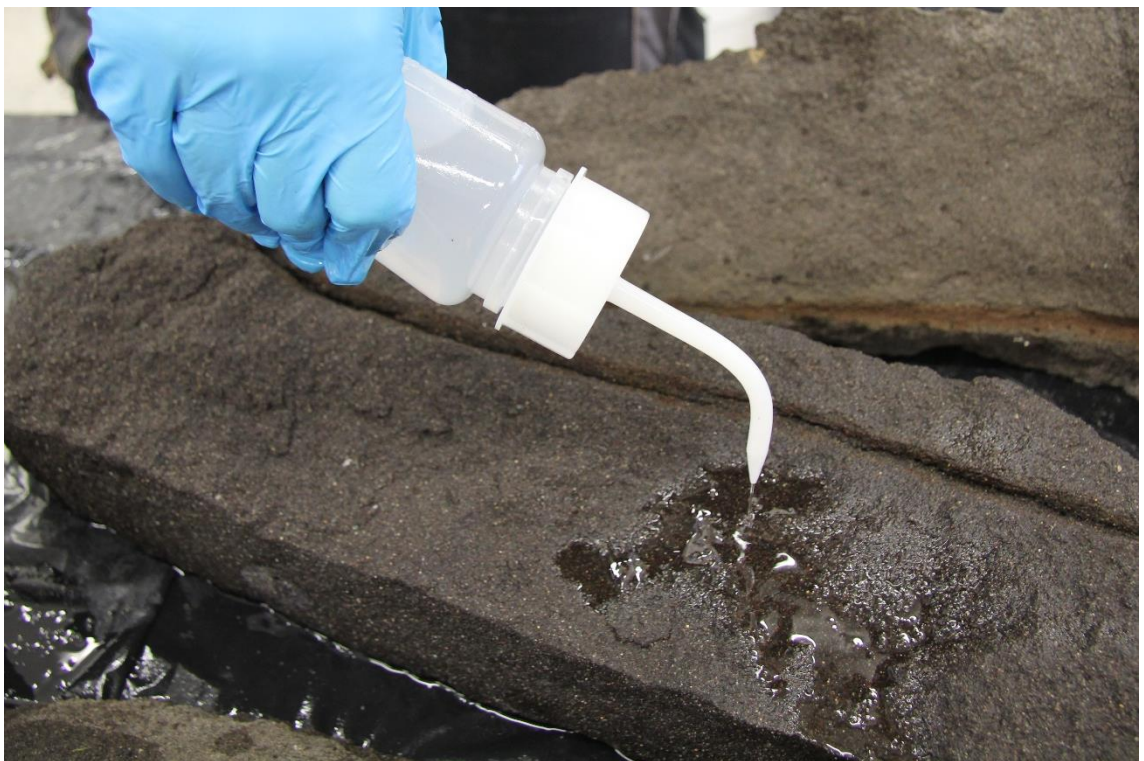
obr. 33 Aplikace konsolidantu poléváním pomocí laboratorní stříčky
