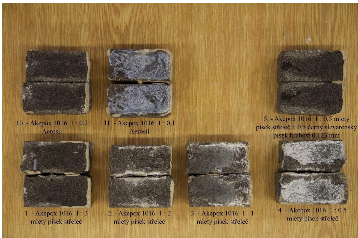
obr. 64 Rozlomené zkoušky injektáže
