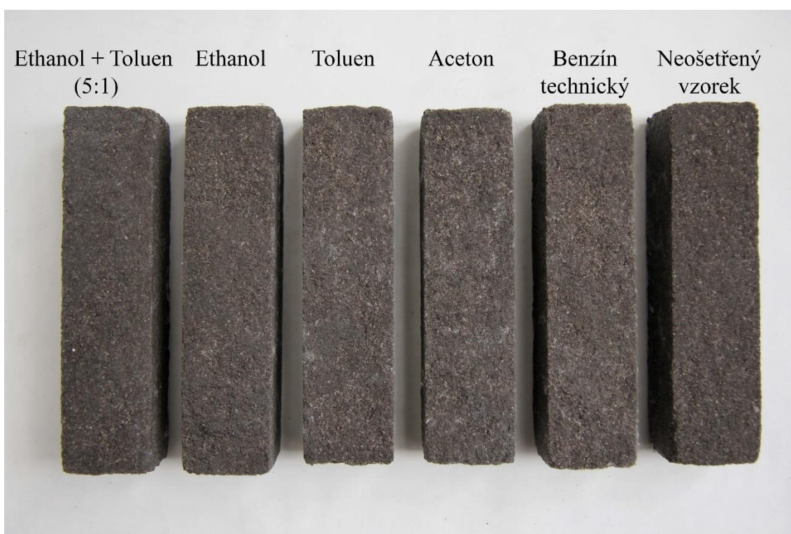
obr. 61 Zkouška omezení barevnosti pomocí otupování povrchu nevytvrdlé epoxidové pryskyřice
