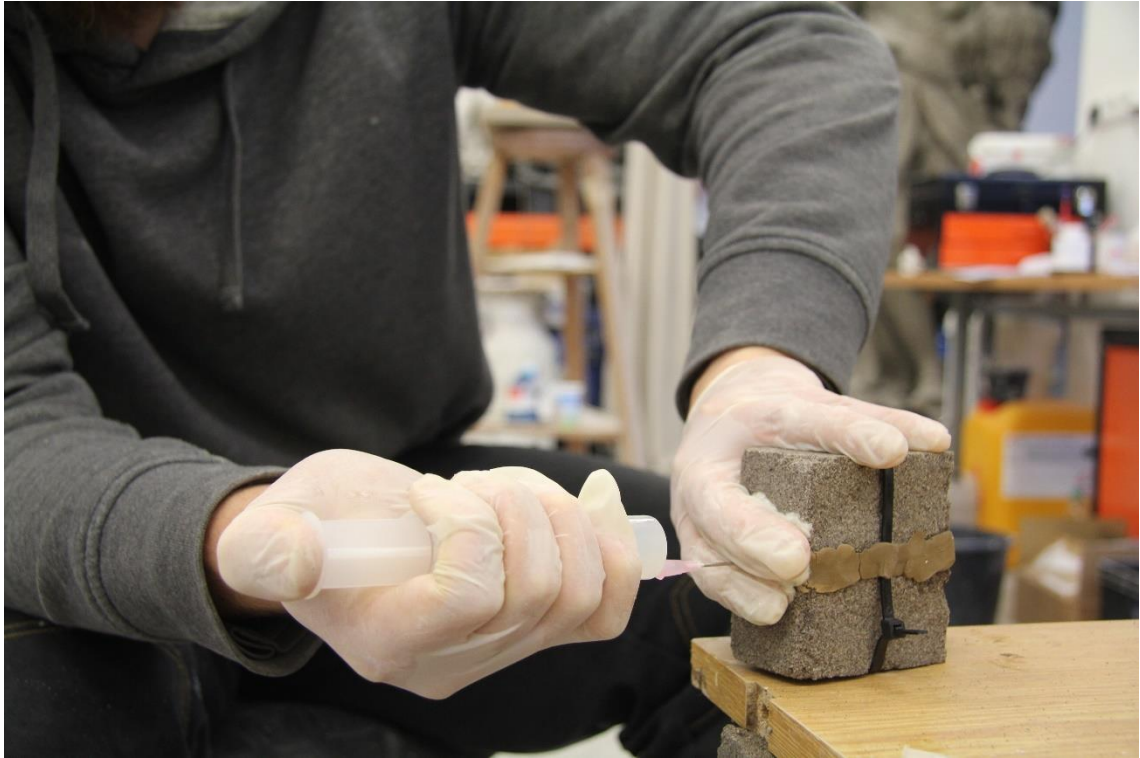
obr. 63 Průběh zkoušky injektáže
