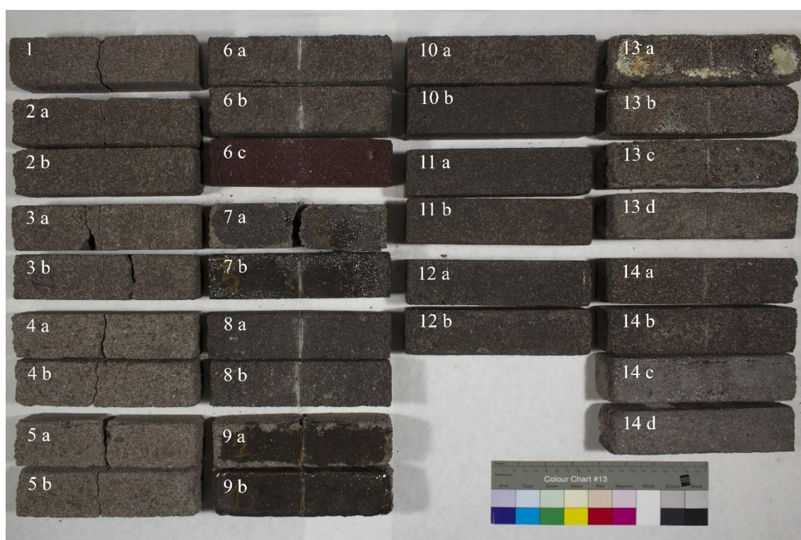
obr. 29 Barevnost a vzhled nekonsolidovaného a konsolidovaných vzorků. Zdokumentovaný povrch strany, kterou se vzorek napouštěl 121
