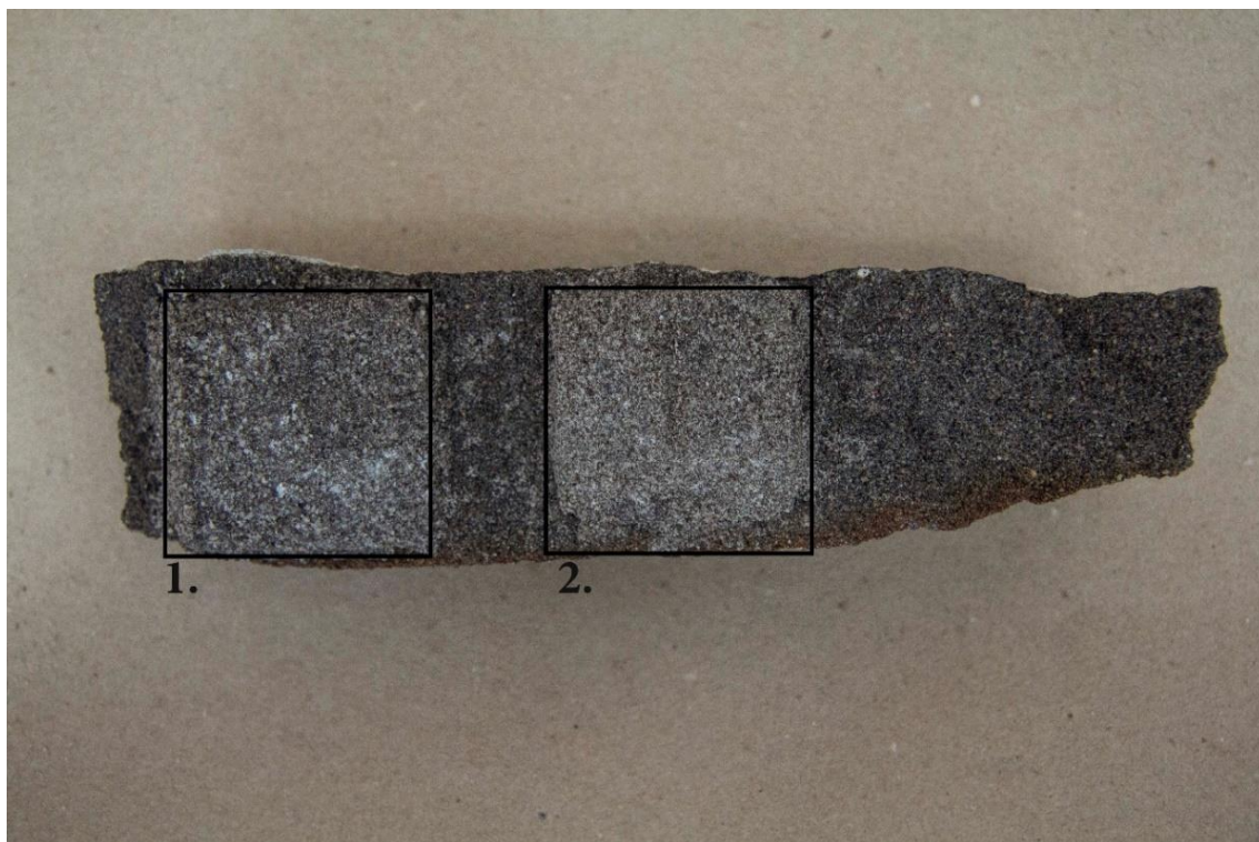
obr. 57 Zkoušky tmelů: 1. 1:12 - směs písků: 1,5 dílu Slévárenského písku (Vysoké Mýto), 1 díl písku Střeleč o frakci 0,5, 2 díly písku Střeleč o frakci 0,2, 2. 1:12 - směs písků: 2 díly Slévárenského písku (Vysoké Mýto), 3 díly písku Střeleč o frakci 0,2
