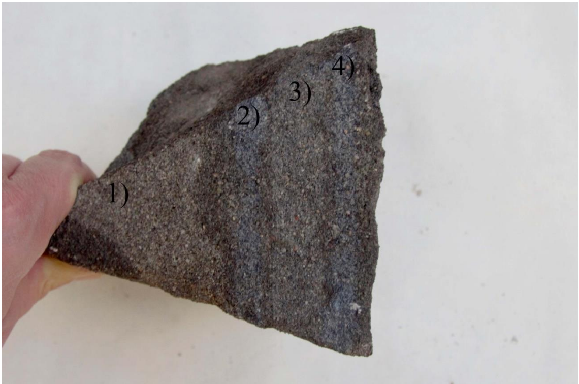
obr. 59 Zkouška omezení barevnosti na úločku faksimile- 1) původní povrch, 2) poklad kalosil E25 následně Kalosil E25 + TiO 2 4% + ZnO 4%, 3) mikropískování zpevněného povrchu bílý korund 220 o 3 až 4 barech, 4) Calosil E25 + E25 + TiO 2 4% + ZnO 4%
