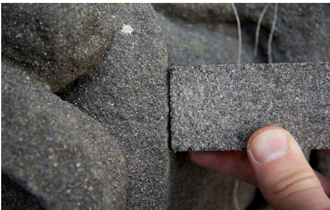
obr. 58 Zkouška tmelu: 1:15 – směs písků: 1,5 dílu Slévárenský písek (Vysoké Mýto), 1 díly písku Střeleč o frakci 0,5, 2 díly písku Střeleč o frakci 0,2
