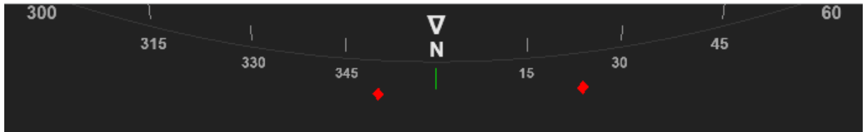
Obrázek 17: HUD prvek zobrazující lištu kompasu (zdroj vlastní)
