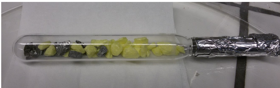
Obrázek 3 Příklad prvků navážených v křemenné ampuli (v tomto případě se jedná o síru, antimon a germanium)
