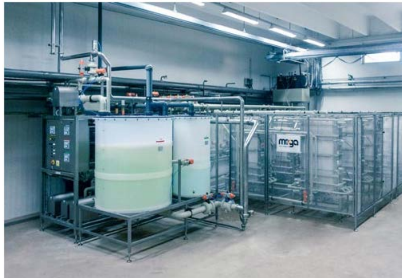
Obrázek 10: Demineralizace syrovátky pomocí elektrodialýzy (výrobce zařízení Mega a.s.) [38]
