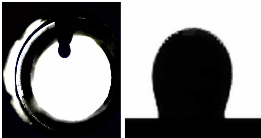
Obrázek 12: Vlevo neupravená fotografie pořízená kamerou, vpravo vhodně upravená fotografie kapky jakožto vstup pro výpočet povrchového napětí pomocí programu OriTas
