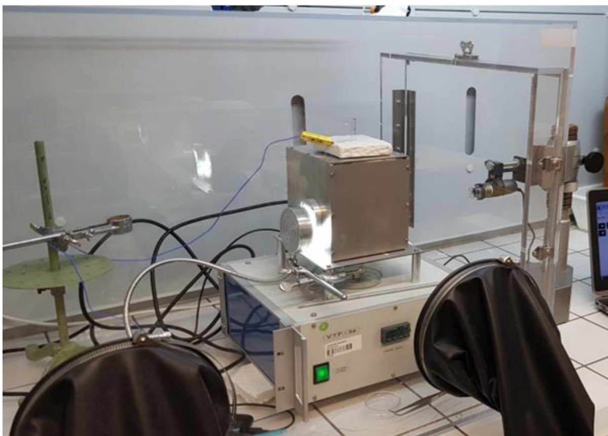
Obrázek 9: Aparatura pro měření povrchového napětí tavenin metodou visící kapky
