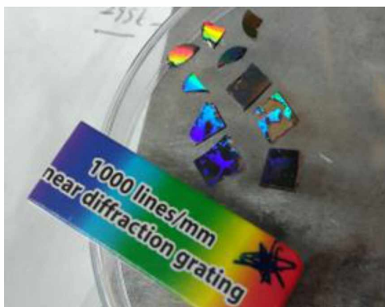
Obrázek 16: Vzorky amorfního selenu s vtištěnou mřížkou s periodou \lambda = 1000 nm
