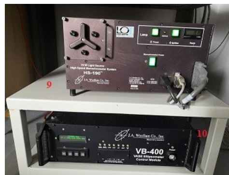
Obrázek 3.2.4: Spektroskopický elipsometr VASE (Woolam Ltd.) – 9-monochromátor, 10-řídící jednotka
