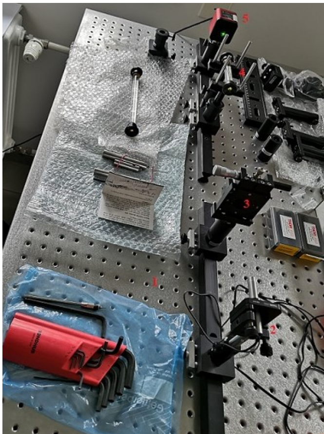
Obrázek 3.2.6: Polarimetr PAX1000 (THORLABS) – 1-optická deska, 2-laserová dioda, 3-Glan-Thompsonův polarizátor, 4-kyveta s cukerným roztokem, 5-analyzátor
