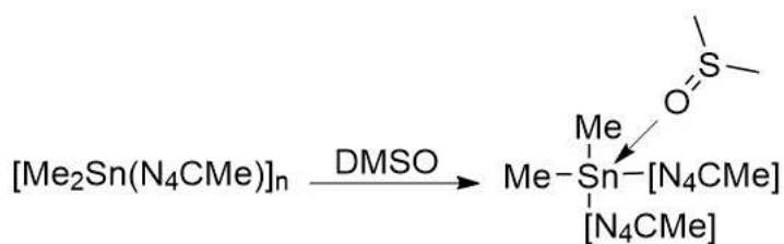
Obrázek 4.2: Schematické znázornění rozpadu předpokládaného koordinačního polymeru [\text{Me}_2\text{Sn}(\text{N}_4\text{CMe})_2]_n na monomerní jednotky účinkem DMSO.
