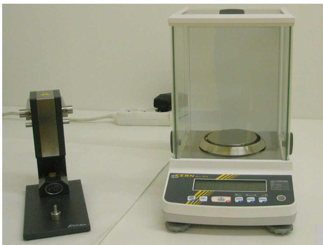
Obrázek 9: Analytická váha k navážování vzorku amorfního Griseofulvinu a speciální lis k hermetickému uzavření kelímků se vzorky
