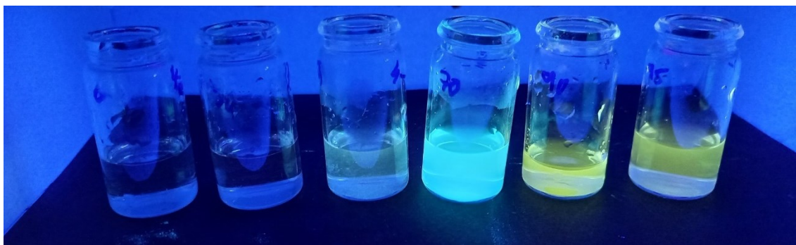
Obr. 29: AIE efekt oxazaborinu 55b ve směsi DMF/H 2 O (zleva: 0 %, 30 %, 50 %, 70 %, 90 % a 95 % H 2 O)
