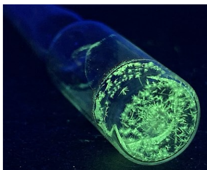
Obr. 30: Fluorescence oxazaborinu 55b v pevné fázi
