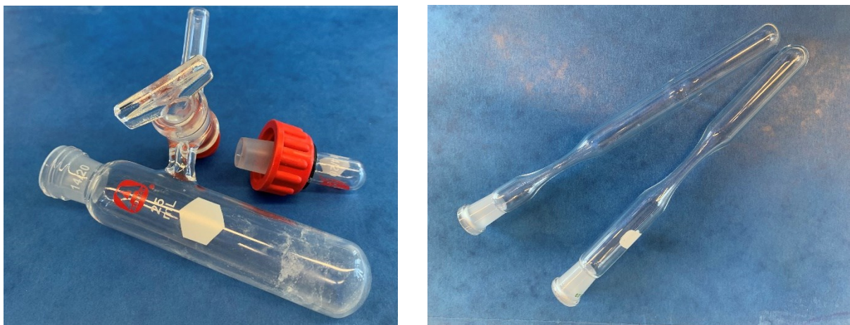
Obrázek 3. Reakční ampule (vlevo) a zábrusové zkumavky (vpravo) používané při syntézách
