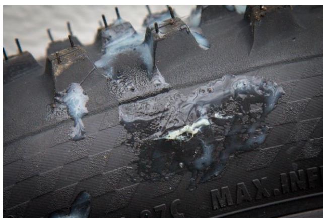
Obrázek 16: Čerstvý defekt pneumatiky. Na obrázku je patrné zacelení kevlarovými vlákny obsaženými v bezdušovém tmelu Finish Line [35]
