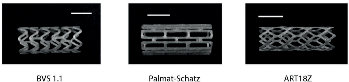
Obrázek 16 Vytištěné geometrie PLA stentů. Převzato a upraveno z [8]
