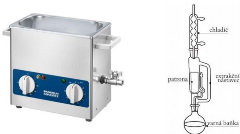
Obrázek 12: Možnosti extrakce: ultrazvuková lázeň (vlevo) [35], Soxhletův extraktor (vpravo) [36]
