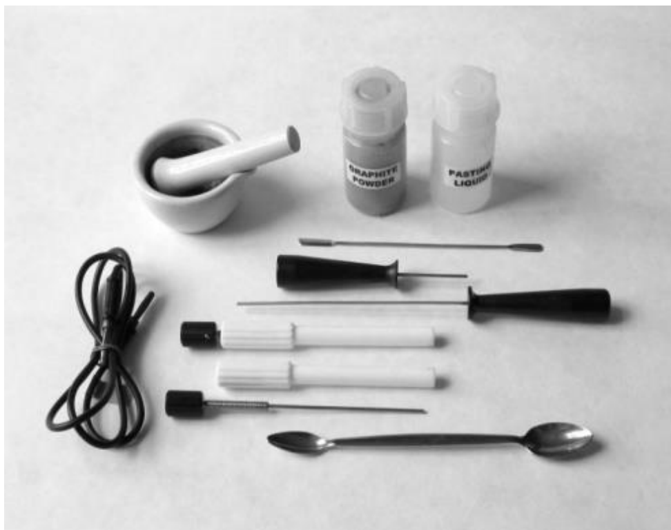
Obrázek 13: Materiály a vybavení potřebné k přípravě uhlíkových patových elektrod [49]
