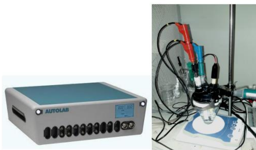
Obrázek 14: - Elektrochemický analyzátor PGSTAT128N (vlevo), Měrná cela s tříelektrodovým zapojením, laboratorním stojanem a magnetickou míchačkou (vpravo) [49]
