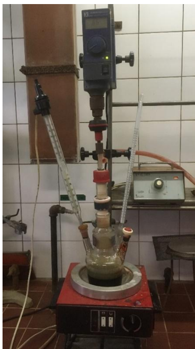
Obrázek 21: Sulfonační aparatura s Vertex teploměrem pro přípravu 2,7-AQDS
