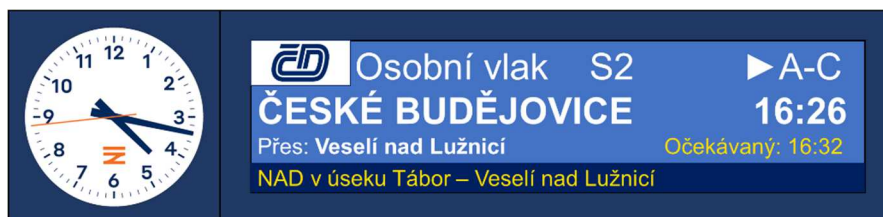
Obrázek H94 – Odjezdová nástupištní tabule s hodinami a logem dopravce
