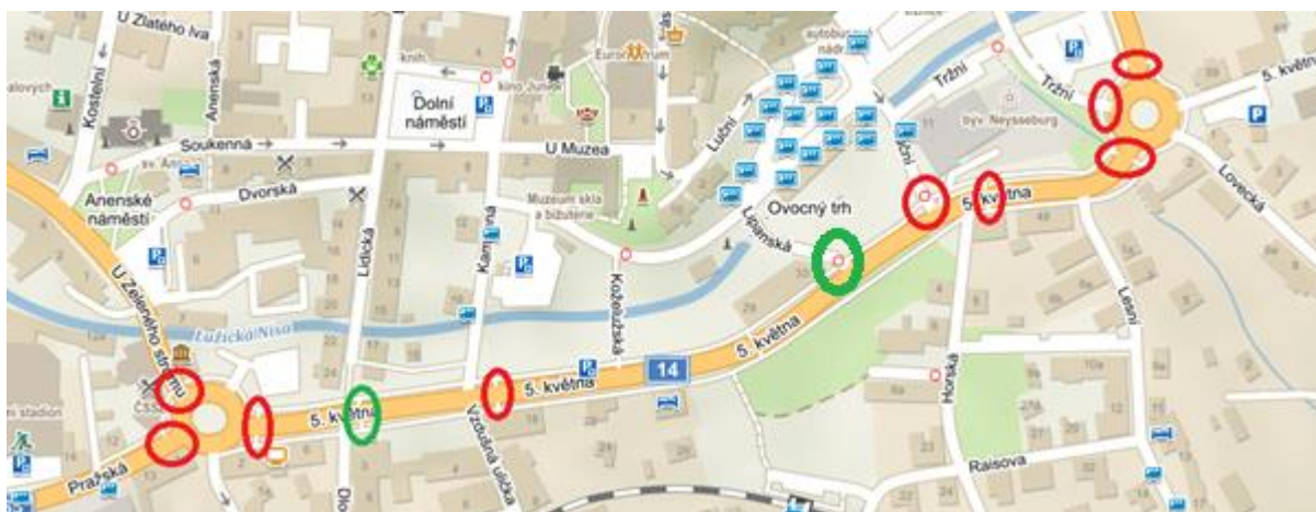
Obrázek 41 Vyznačení středních dělicích ostrůvků v ulici 5. května
