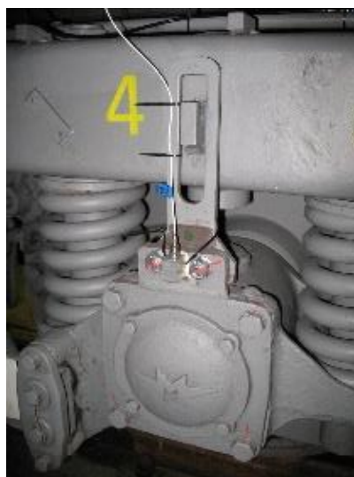
Obr. 20 – snímač zrychlení umístěný na víku nápravového ložiska, autor: Ing. Jakub Vágner, Ph.D
