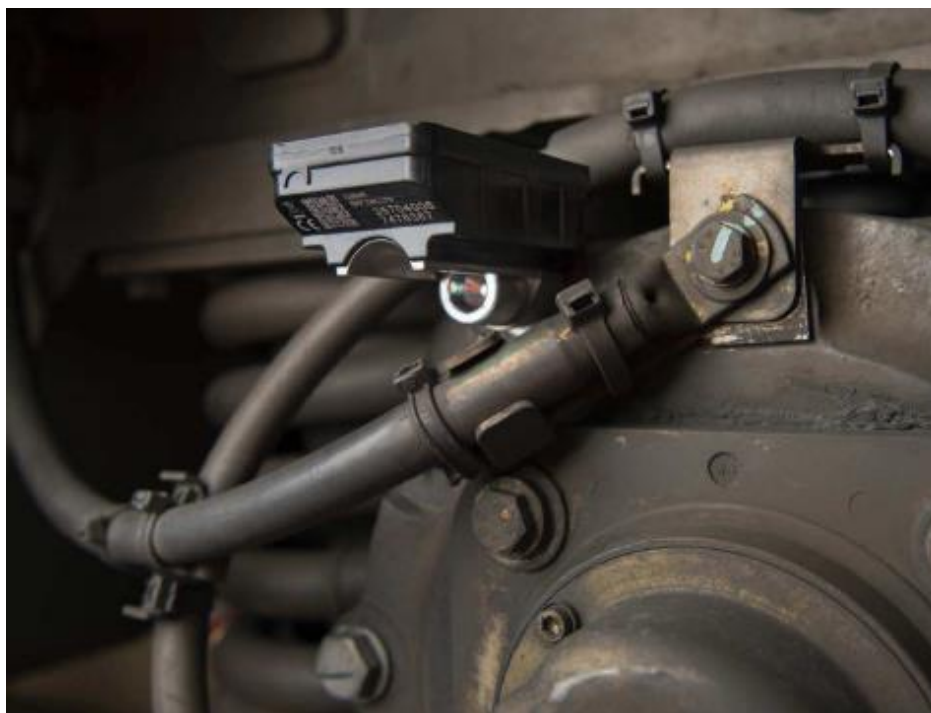
Obr. 7 – SKF Insight Rail připevněný k víku nápravového ložiska [18]
