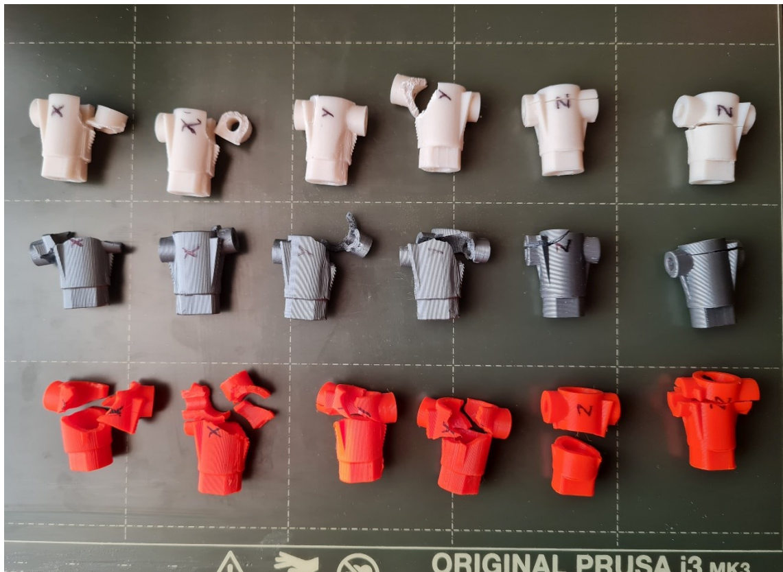
Obrázek 28 – Natrhané vzorky úchytu pro šroub
