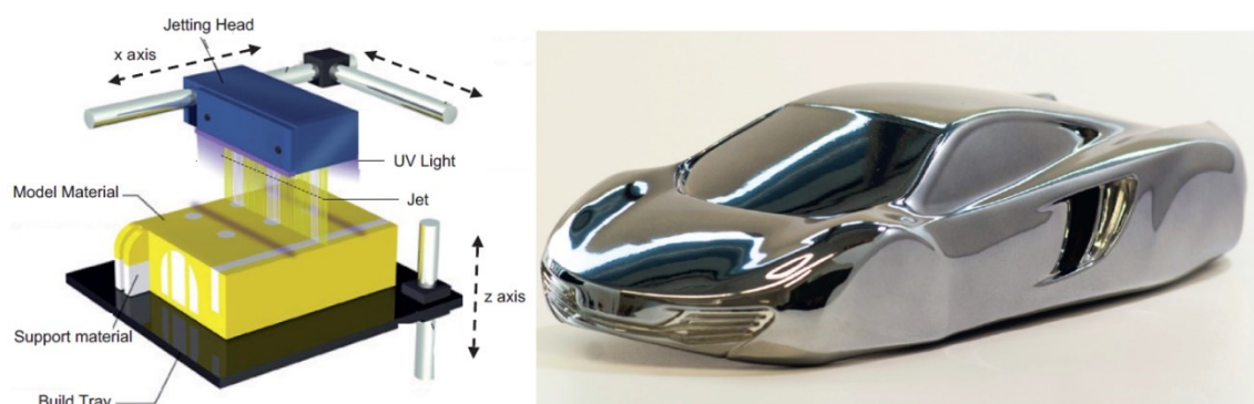
Obrázek 4 - Polyjet (vlevo) [4 str. 40]; Galvanizovaný model (vpravo) [4 str. 41]
