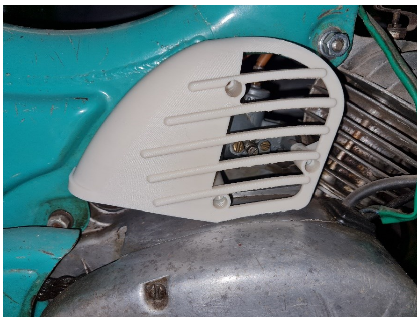
Obrázek 44 - Finální díl z materiálu ASA
