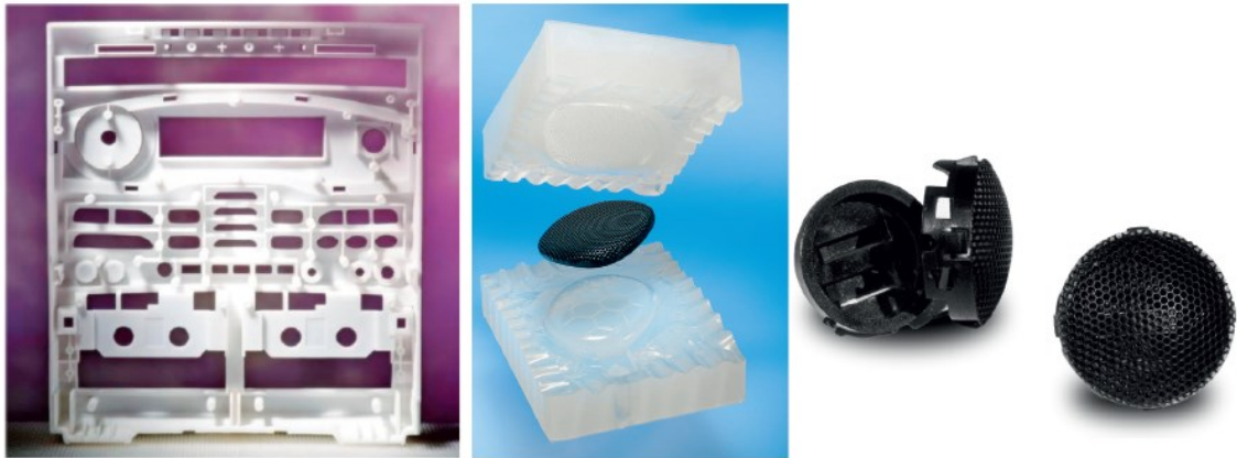
Obrázek 3 - Palubní deska (vlevo) [4 str. 103]; Silikonová forma (uprostřed), Odlitý model (vpravo) [4 str. 104]
