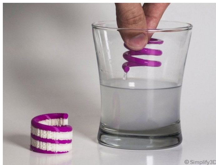
Obrázek 18 - Rozpouštění PVA podpor ve vodě [37]
