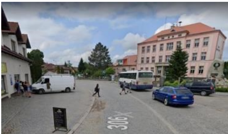
Obrázek 21: Nebezpečná situace pro chodce vzniklá díky absenci přechodu pro chodce (Google, 2019a)
