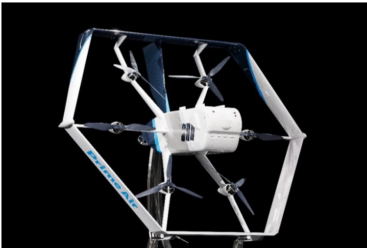
Obrázek 8 Hybridní konstrukce dronu s vertikálním a leteckým režimem (Wilke, 2019)
