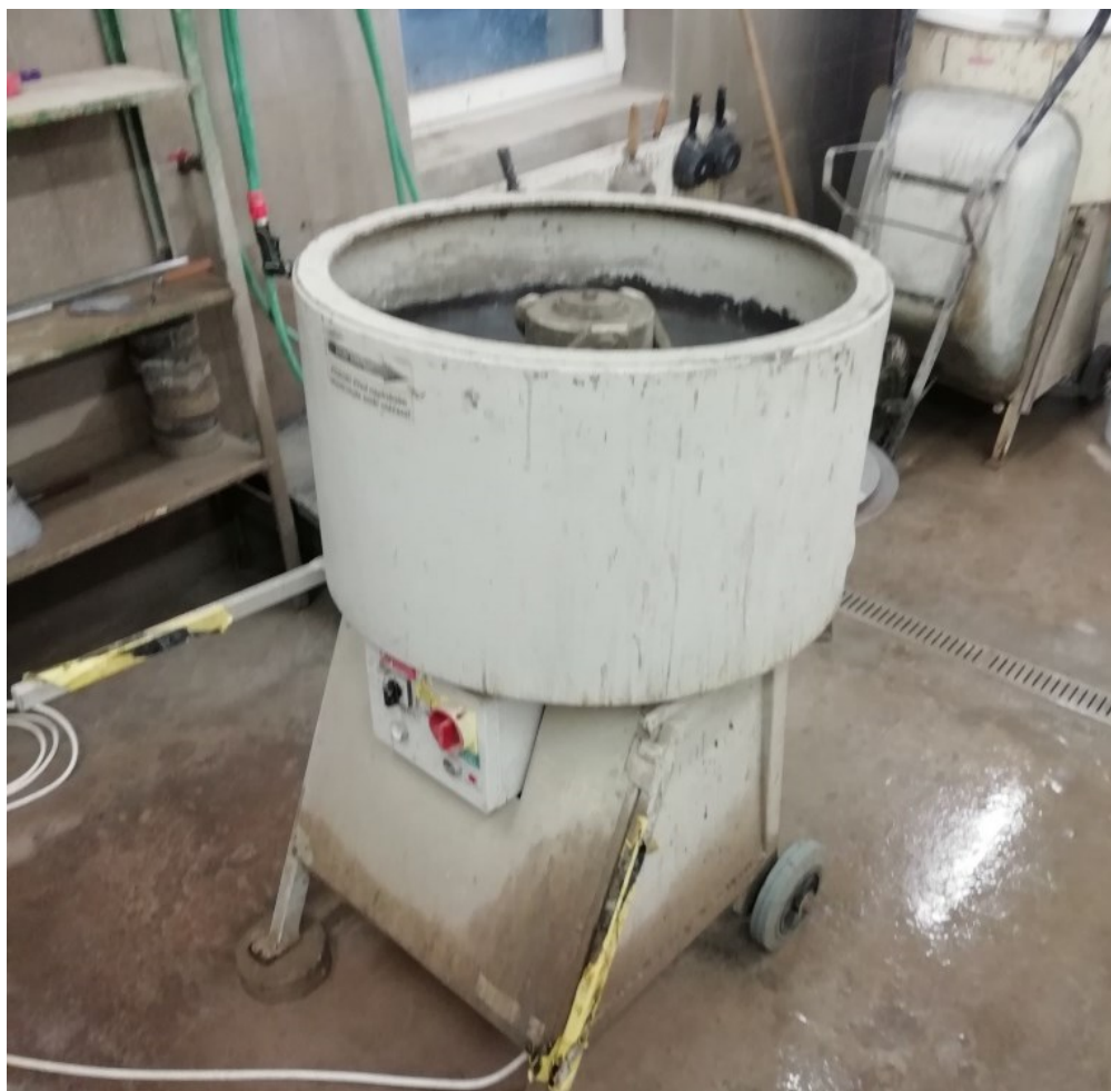
Obrázek 51 Laboratorní míchačka s nuceným oběhem
