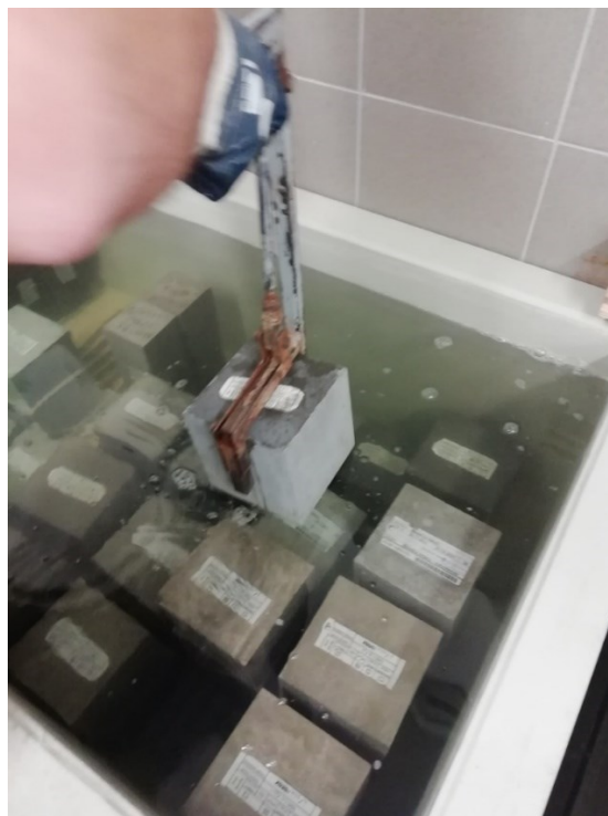
Obrázek 66 Ukládání zkušebních těles do vodní lázně
