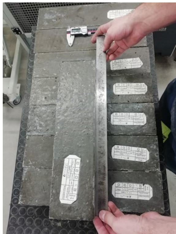
Obrázek 69 Měření délky ocelovým kalibrovaným měřidlem
