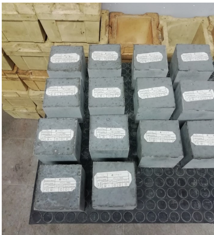
Obrázek 62 Odformovaná zkušební tělesa K100 po 24 hodinách
