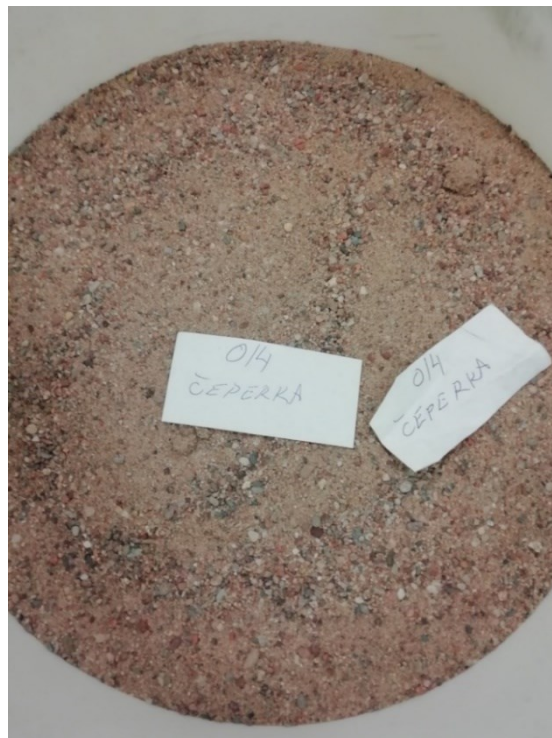
Obrázek 38 Těžené kamenivo Čeperka fr. 0/4
