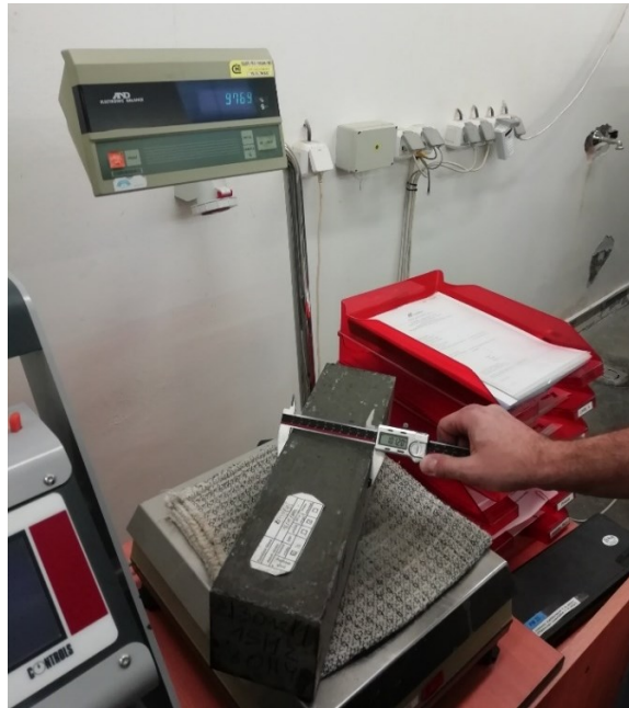
Obrázek 68 Vážení zkušebních těles a měření posuvným měřítkem
