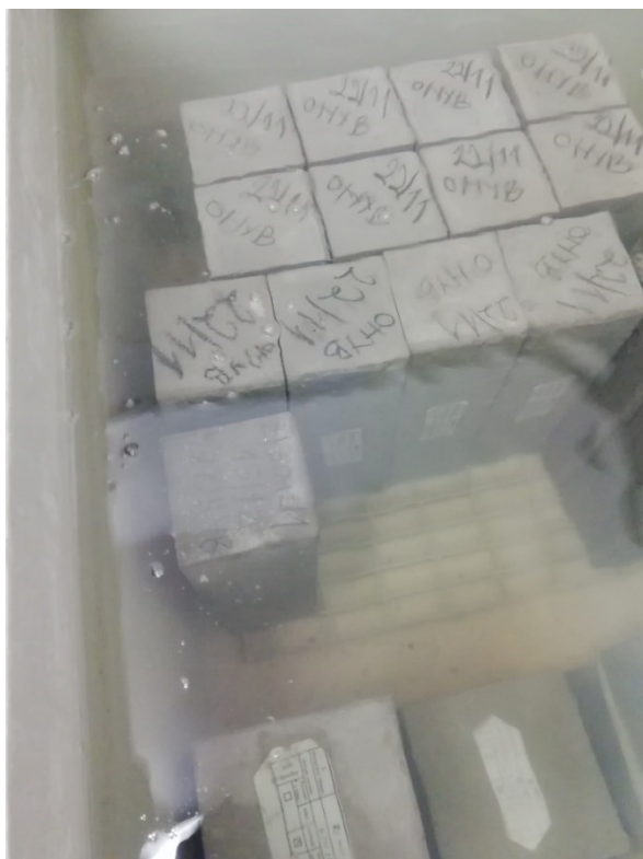
Obrázek 67 Trámce uložené ve vodní lázni
