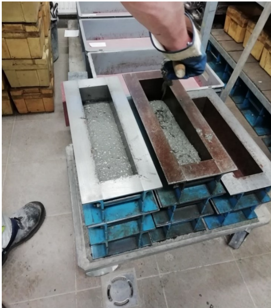
Obrázek 58 Ukládání čerstvého UHPC do forem trámů (T400)
