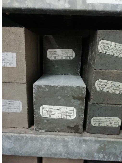
Obrázek 65 Uložená tělesa do regálů v komoře
