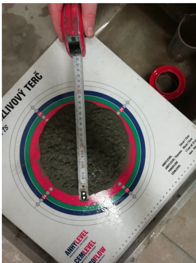
Obrázek 55 Měření průměru rozlivu na malém rozlivovém terči
