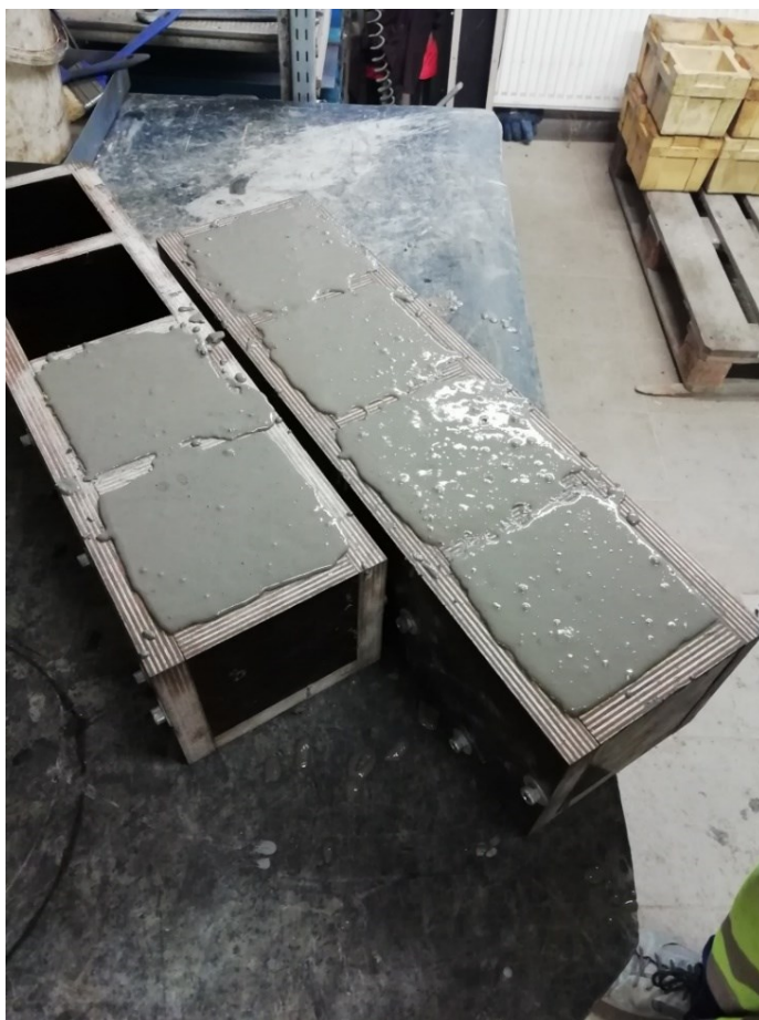
Obrázek 61 Naplněné formy krychlí (K100)
