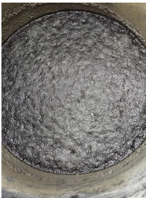
Obrázek 53 Vytlačování mikrosiliky superplastifikátorem po vypnutí míchačky
