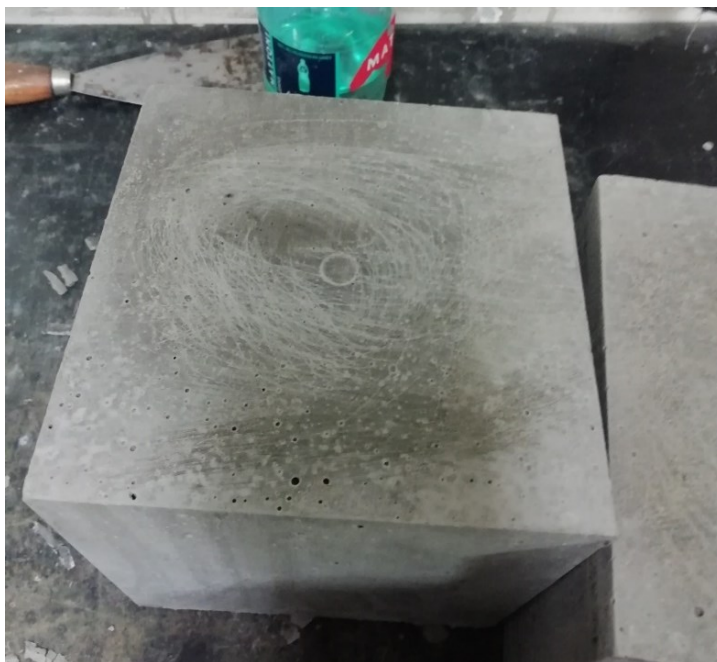
Obrázek 73 Zdrsnění povrchu zkušebního tělesa ocelovým kartáčem před zkouškou průsakem
