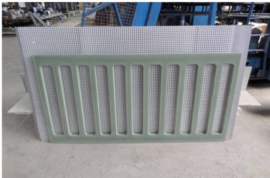
Obrázek 14 Díl zábradlí vyrobeného z UHPC [40]
