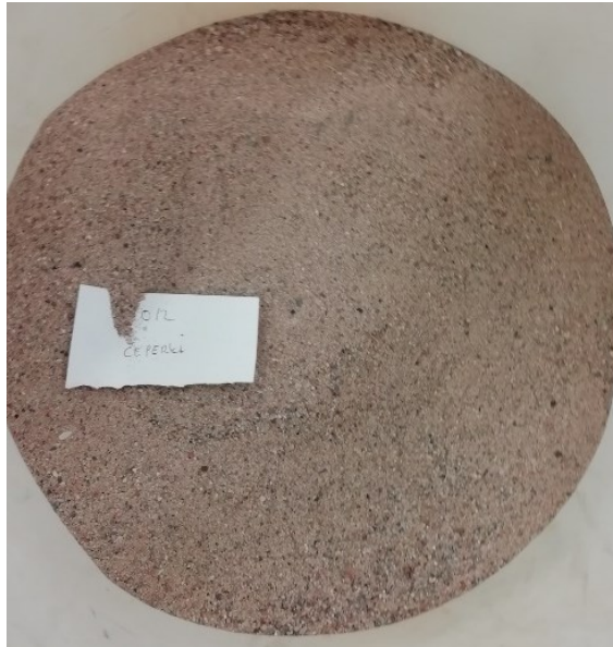
Obrázek 37 Těžené kamenivo Čeperka fr. 0/2
