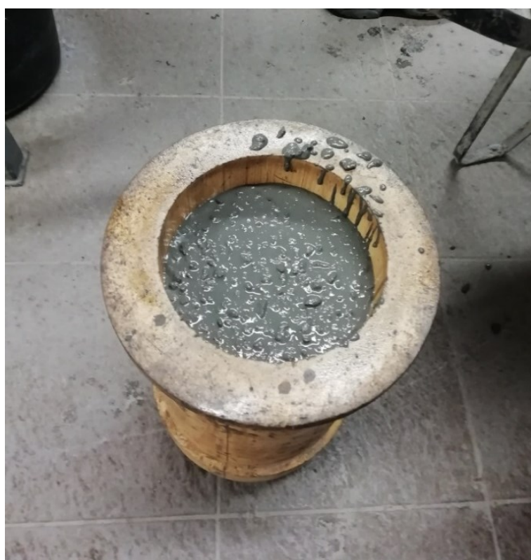
Obrázek 60 Výroba zkušebních těles – válec (V300)
