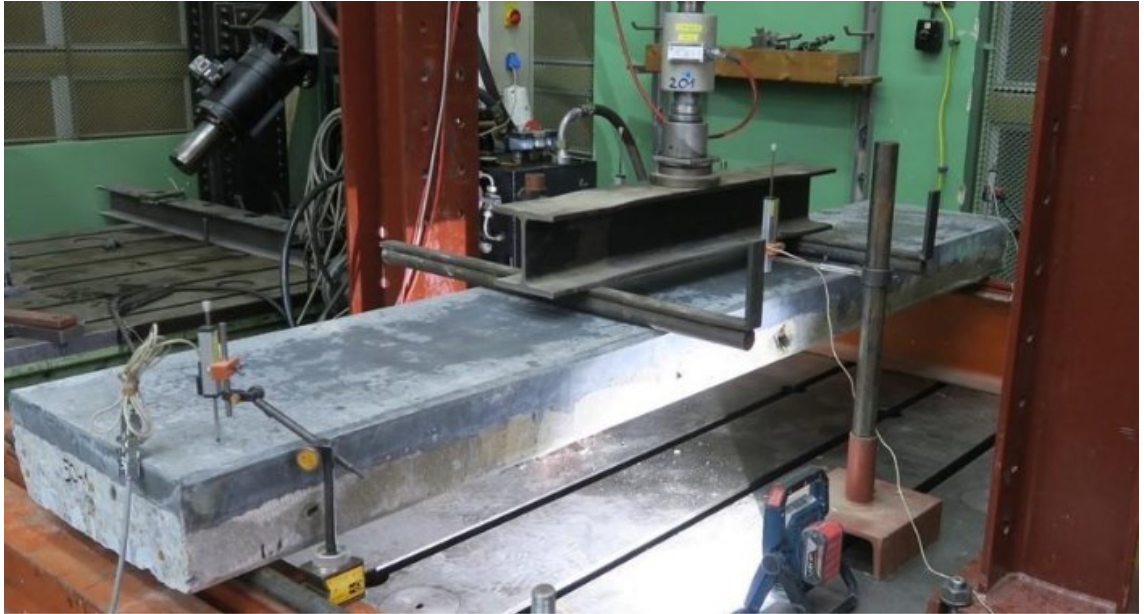
Obrázek 19 Laboratorní zkouška nosníku s nabetonávkou z UHPC [50]
