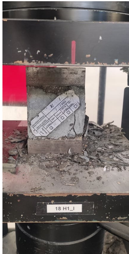
Obrázek 71 Rozdrčené zkušební těleso K100 po tlakové zkoušce
