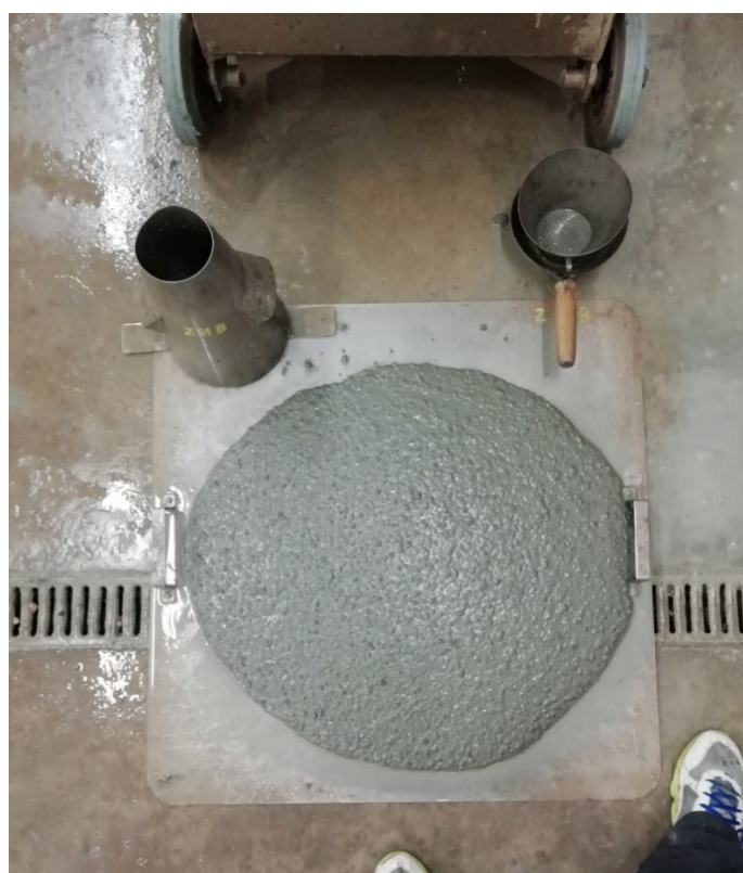
Obrázek 56 Měření průměru rozlivu na velkém rozlivovém terči
