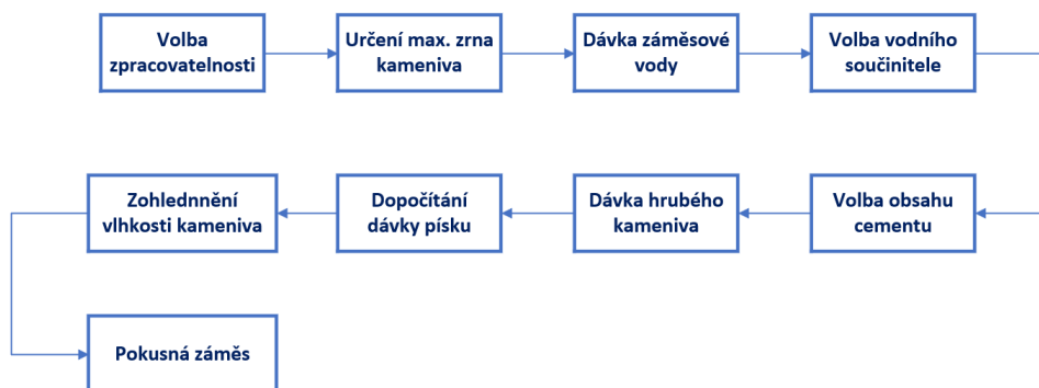
Obrázek 31 Schématický vývojový diagram návrhu metodou ACI 221-1 [5]
