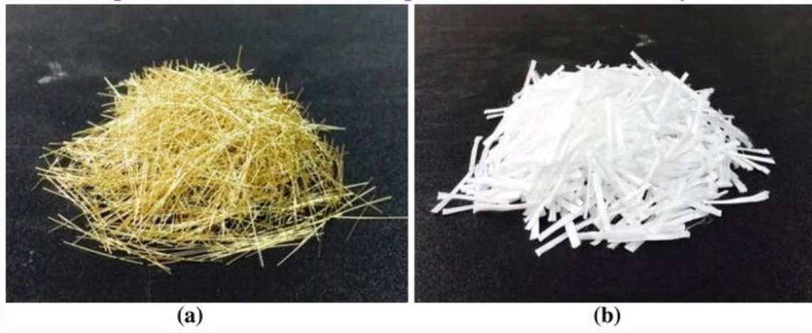
Obrázek 28 Příklad vláken používaných do UHPC, (a) drátky z uhlíkové oceli potažené mosazí, (b) polymerní vlákna [65]
