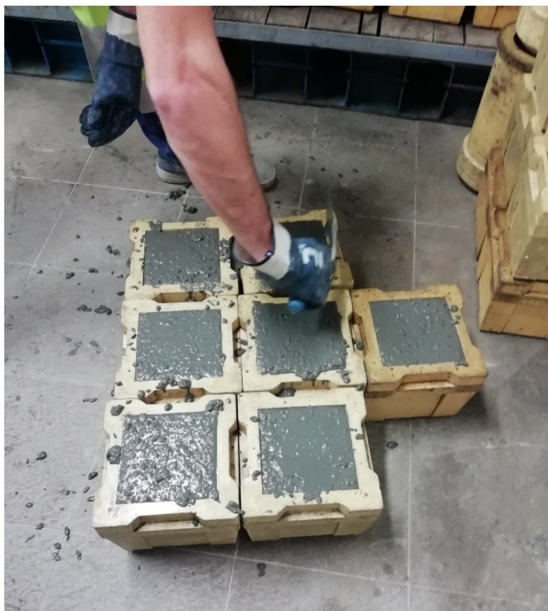
Obrázek 59 Výroba zkušebních tělese – krychle (K150)
