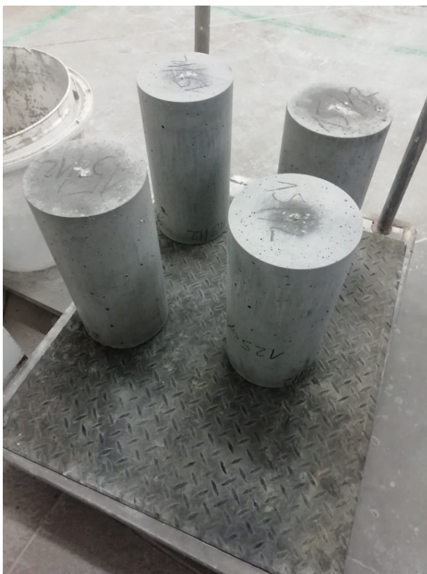
Obrázek 63 Odformovaná zkušební tělesa V300 po 24 hodinách
