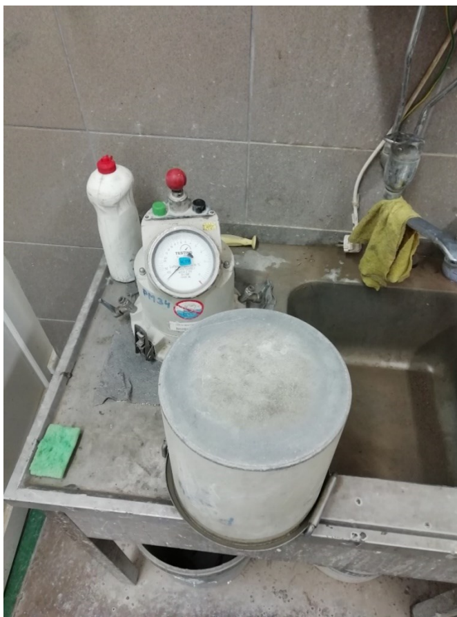
Obrázek 57 Zařízení pro měření obsahu vzduchu čerstvého betonu
