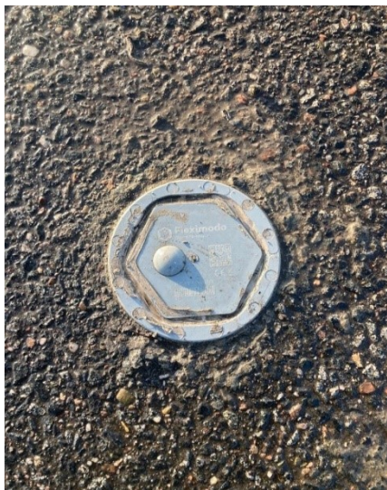
Obrázek 14 Senzor pro detekci vozidla v rámci projektu Smart parking
