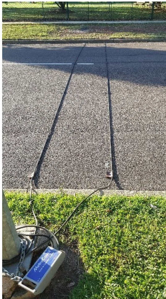
Obrázek 5 Pneumatické trubice umístěné na povrchu vozovky [12]
