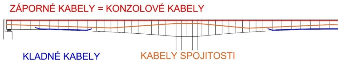
Obrázek 30 – Podélné předpětí při letmé betonáži
